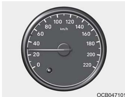
车速表指示车辆的速度，车速表标准单位为千米每小时 (km/h)。
