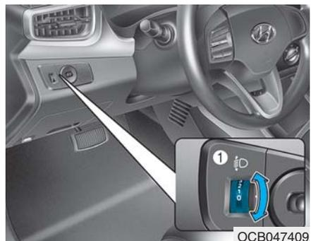
根据乘员数及行李区的装载重量，转动大灯水平调整开关调整大灯光束照射点位置。
