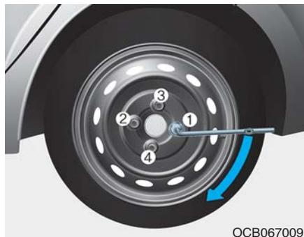
13. 使用车轮螺母扳手按所示的顺序拧紧车轮螺母。确认每个车轮螺母牢固拧紧。更换轮胎后，请尽快请北京现代授权经销商按规定扭矩拧紧车轮螺母。
