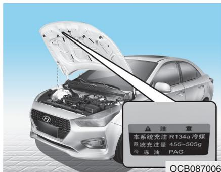
制冷剂标签位于发动机罩底部。
