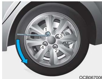
6. 按顺序逆时针方向转动每个车轮螺母 1 圈来松动车轮螺母，但在轮胎离地之前不要完全拧下螺母。
