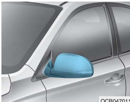
驾驶车辆前一定要调整后视镜角度。您车辆配备了左侧和右侧室外后视镜。可以使用远程控制开关远程调整后视镜。
