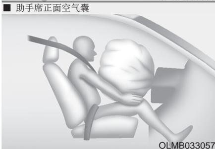
空气囊完全展开后立即开始放气，使驾驶员能够维持前方视野并能执行转向或操作其它控制。
