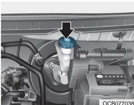
定期检查储油罐内的油量。油量应在储油罐侧的 MAX 与 MIN 标记之间。在拆下储油罐盖及添加制动油 / 离合器油前，完全清洁储油罐盖周围，以免污染制动油 / 离合器油。
