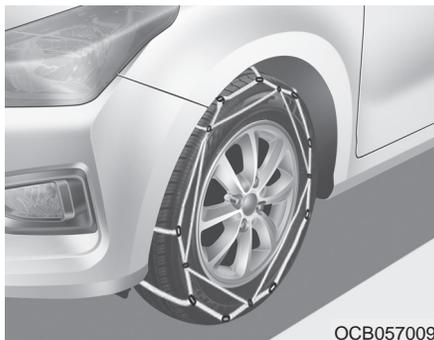
由于子午线轮胎侧围比其它类型的轮胎薄，如果在其上装配某些类型的防滑链，可能会损坏轮胎。因此使用推荐的防滑轮胎代替防滑链。不要在配备铝制车轮的车辆上安装轮胎防滑链；如果不可避免，使用导线防滑链。如果必须使用防滑链，使用北京现代正品配件并在审阅防滑链提供的说明书后，安装轮胎防滑链。由于防滑链使用不当而导致的车辆损坏，不属于车辆制造商的保修范围内。
