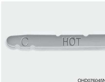
3. 确认油位是否在油位表的“HOT”范围内。如果油量较少，通过加油孔补充指定变速器油。如果油量较多，通过排油孔排出变速器油。
