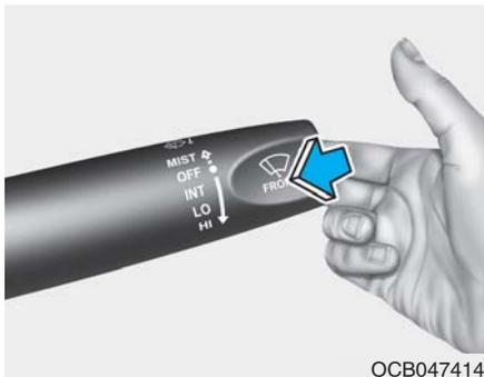
在 OFF 位置，朝您的方向轻拉开关杆，向挡风玻璃喷射清洗液并运转雨刮器 1-3 周期。喷水器及雨刮器持续工作，直到您释放开关杆为止。如果喷水器不工作，可能需要在喷水器液储液箱内添加喷水器液。
