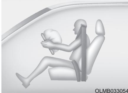
当 SRSCM 检测到车辆正面碰撞严重性达到一定程度时，自动展开正面安全气囊。
