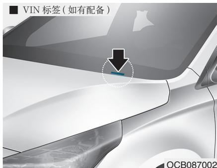
在仪表板顶部附着板件上也有 VIN, 从外部透过挡风玻璃可轻易看到此板件上的号码。
