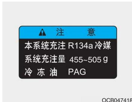
实际车辆内的空调制冷剂标签可能与图示不同。
