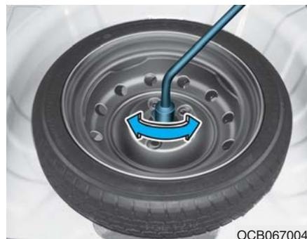
如果用手难以拧下备胎蝶形螺栓，使用车轮螺母扳手可轻易拧下此螺栓。使用车轮螺母扳手逆时针方向转动备胎压紧蝶形螺栓。
