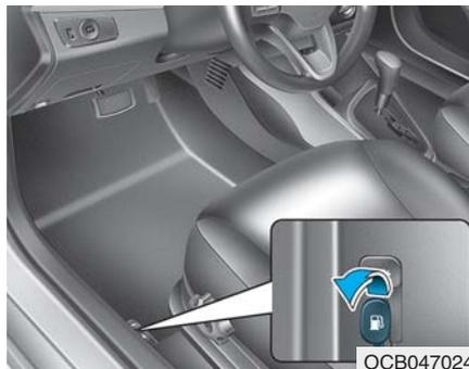
在车内拉起燃油加油口门释放杆，可以打开燃油加油口门。
