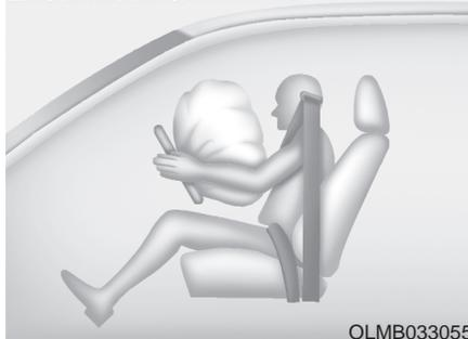
安全气囊展开时，直接模压在装饰盖内的撕裂接缝会在安全气囊的膨胀压力下作用被分离。装饰盖进一步打开，安全气囊膨出完全展开。
