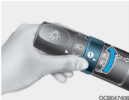
雾灯用于在雾、雨、雪等导致能见度不良时提高能见度。雾灯开关位于灯光控制杆末端灯光开关的旁边。
