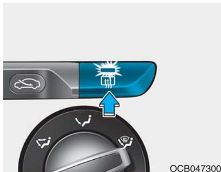
发动机运转期间除霜器加热后窗，从而除去后窗内外的霜、雾和薄冰。
