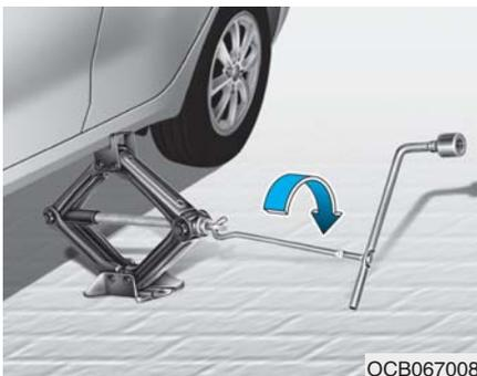
8. 把千斤顶手柄插入千斤顶并顺时针旋转，举升车辆直到轮胎刚好离地，确定车辆在千斤顶上静止。
