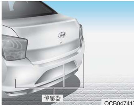
在倒车过程中，驻车距离警告（倒车）系统向驾驶员提供帮助，如果检测到在车辆后方约 100cm(39in.) 的距离内有物体存在，该系统会发出警报声。系统只能检测在规定范围内和传感器位置处的物体，不能检测其它没有安装传感器区域内的物体。
