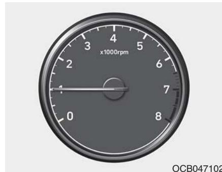
转速表指示发动机每分钟的转数 (rpm)。
