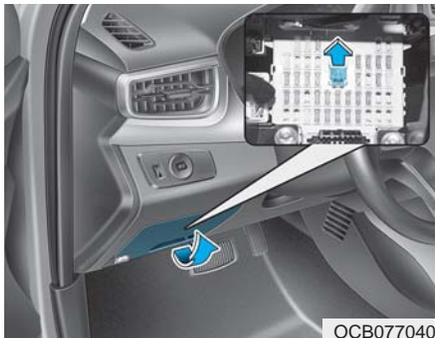
您的车辆配备了记忆保险丝(短接连接器),用于防止长时间不驾驶车辆的驻车状态下蓄电池放电。长时间驻车前执行下列程序:
