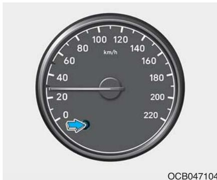
使用方向盘上的行车电脑/复位 (TRIP/RESET) 按钮可变换 LCD 显示器模式。
