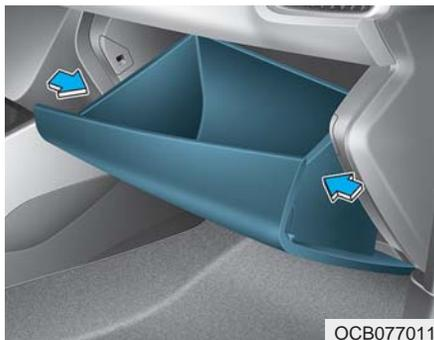
1. 在手套箱打开状态，按压两侧放低手套箱。
