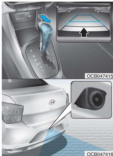
在发动机运转状态下，把变速杆挂到 R 档 (倒档) 时，后视摄像头启动。
