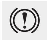
把点火开关转至 ON 位置（不起动发动机），检查驻车制动警告灯。
