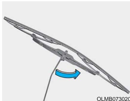
1. 举起雨刮器臂并旋转雨刮器刮片总成，以便露出塑料锁定夹。
