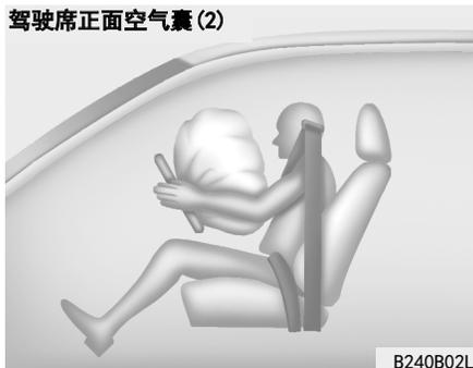
空气囊展开时，直接模压在装饰盖内的撕裂接缝会在空气囊的膨胀压力作用下被分离。装饰盖进一步打开，空气囊完全展开。
