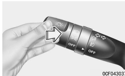
要打开大灯远光，应向远离您的方向推灯光控制杆。往回拉灯光控制杆即可打开近光。
