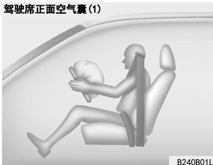
正面空气囊总成位于方向盘中央和助手席前手套箱上方的仪表板内。当SRSCM检测到车辆正面碰撞严重性达到一定程度时，自动展开正面空气囊。
