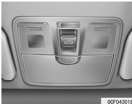
如果您的车辆配备天窗，您可以使用车顶控制台上的天窗控制杆滑动或倾斜操作天窗。
