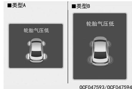
轮胎压力监测系统警告灯亮时，仪表盘LCD显示器上显示一条警告信息，说明您车辆的一个或多个轮胎充气压力明显不足。
