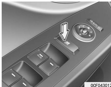
驾驶员可以通过把电动门窗锁止开关按到“LOCK(锁止)”位置(按下)来停用后乘员车门上的电动门窗开关。
