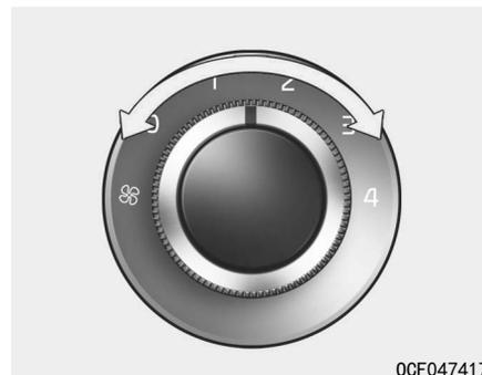
点火开关必须在ON位置,才能进行鼓风机速度操作。
