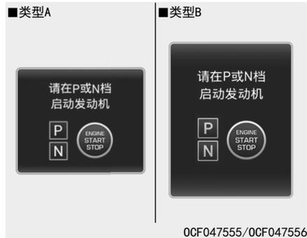
如果您尝试在没有将变速杆置于P(驻车)或N(空档)位置的情况下启动发动机，此警告信息亮。
