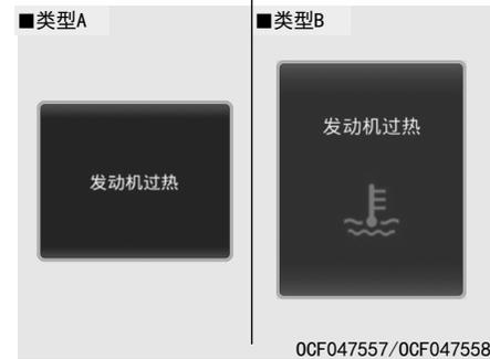
当发动机冷却水温度大于120° C(248° F)时，此警告信息闪烁。这意味着发动机过热，可能损坏发动机。如果您的车辆过热，请参考第6章的“发动机过热”部分。
