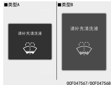
如果清洗液储液箱内的清洗液位接近空, 维护提示模式上的此警告信息亮。重新注入喷水器液。
