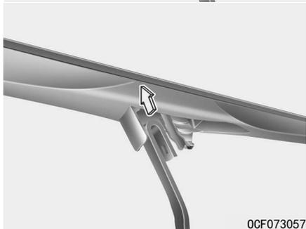
2. 压住锁定夹并向下滑动雨刮器刮片总成。
