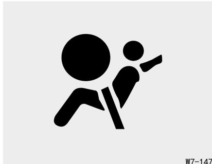
仪表板上的安全气囊警告灯用于警告您安全气囊-辅助保护系统(SRS)可能有故障。当点火开关置于ON位置时,警告灯亮约6秒钟,然后熄灭。
