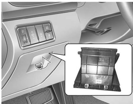
使用北京现代授权诊断设备可从ECU上找到VIN。将诊断设备连接到室内保险丝盒上的OBD连接器上，有关详细信息请联络北京现代授权经销商。
