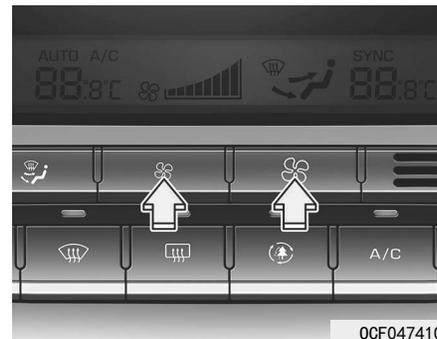
通过操作鼓风机速度控制按钮，可把鼓风机速度设定到理想速度。
