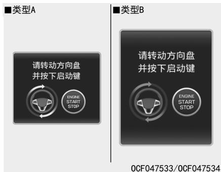
如果在按下发动机起动/停止按钮时，方向盘没有正常开锁，此警告信息亮。
