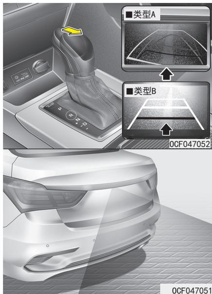
当发动机运转并变速杆置于R(倒档)位置时, 后视镜摄像头启动。
