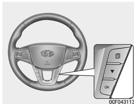
使用方向盘上的控制按钮可变换LCD显示器模式。
