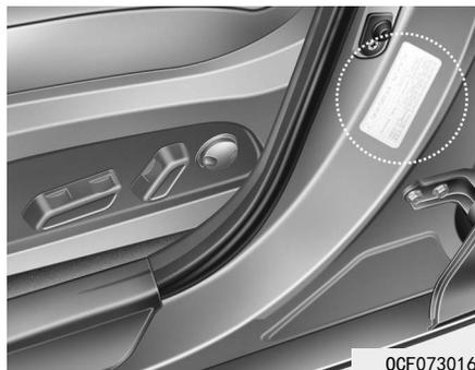
在车辆标签上可以看到所有规格(尺寸与轮胎充气压力)。
