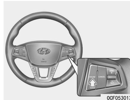
1. 按下方向盘上的/巡航(CRUISE)按钮接通巡航控制系统。巡航(CRUISE)控制指示灯亮。
