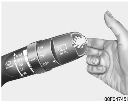
在OFF位置，朝您的方向轻拉开关杆，向挡风玻璃喷射清洗液并运转雨刮器1-3周期。挡风玻璃脏时使用此功能。喷水器及雨刮器持续工作，直到您释放开关杆为止。
