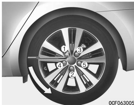
7. 按上面所示顺序，逆时针方向转动每个车轮螺母1圈来松动轮胎螺母，但在轮胎离地之前不要拧下螺母。
