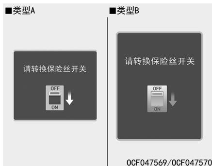
如果方向盘下方的保险丝开关OFF，此警告信息亮。接通保险丝开关。
