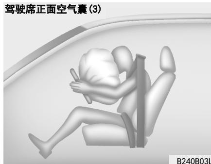
完全展开的空气囊结合正确佩戴的安全带能减缓驾驶员或乘员的前冲运动，降低头部和胸部的受伤机率。
