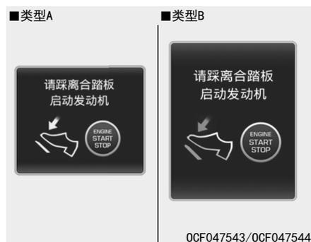
如果在踩下离合器踏板状态重复按下按钮将发动机启动/停止按钮转至ACC位置两次，此警告信息亮。
