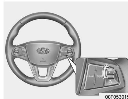
车速超过30km/h (20mph) 时向上移动开关到RES+位置, 车辆将恢复到预设的巡航速度。
