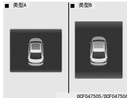
如果在天窗没有完全关闭的状态，驾驶员拔出点火开关钥匙(智能钥匙：发动机OFF)，并打开驾驶席车门，警告音响4秒，LCD显示器上显示天窗开启图像。驾驶员离开车辆时，要确认天窗完全关闭。
