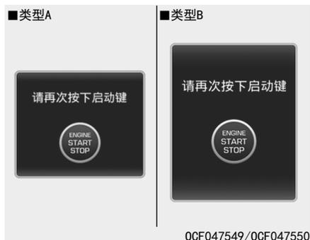
如果在发动机起动/停止按钮系统有故障时不能操作发动机起动/停止按钮,此警告信息亮。
