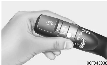
雾灯用于在雾、雨、雪等导致能见度不良时提高能见度。使用靠近大灯开关的开关来开启和关闭雾灯。接通尾灯后把雾灯开关(1)置于ON位置时雾灯亮。
