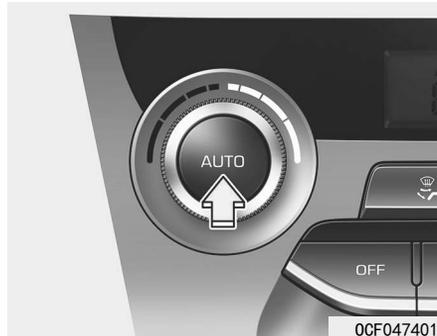
通过显示器上的AUTO标志显示。通过温度设定自动控制通风模式、鼓风机速度、内外气选择及制冷系统的运转。
