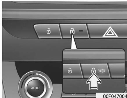
按下门锁闭锁开关 (🔒) 来闭锁门锁。全部车门闭锁，开关上的指示灯约亮60秒钟。如果一个车门处于开锁状态，门锁指示灯将会闪烁。
