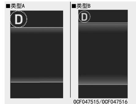
此指示灯显示选择的自动变速器变速杆位置。
