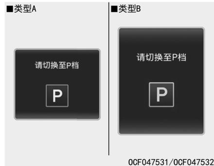
如果您尝试在没有将变速杆置于P(驻车)位置的情况下停止发动机，此警告信息亮。
