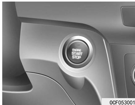
无论何时打开前车门，发动机起动/停止按钮照明灯亮，车门关闭30秒之后照明灯OFF。
