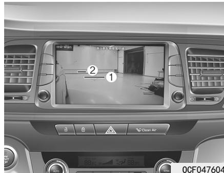
当BVM(后侧方盲区监测)系统在启动状态时，在PI0-视频显示器上显示助手席侧后方区域状态。红色参考线的距离为3米，黄色参考线的距离为12米。
