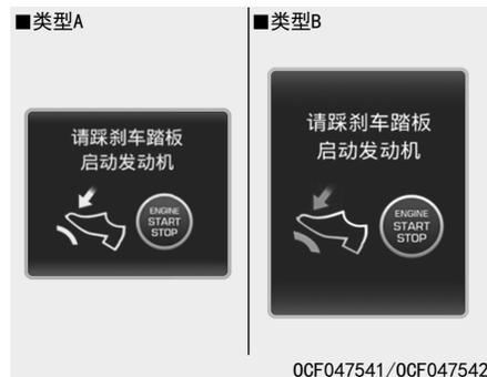
如果在踩下制动踏板状态重复按下按钮将发动机启动/停止按钮转至ACC位置两次，此警告信息亮。
