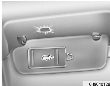
打开化妆镜盖将自动点亮后视镜灯。
