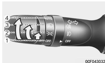
要控制灯光，转动灯光控制杆末端的控制旋钮到下列位置中的一个：
