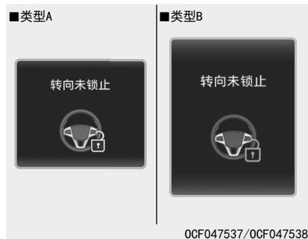
如果在发动机起动/停止按钮转至OFF位置时，方向盘没有闭锁，此警告信息亮。
