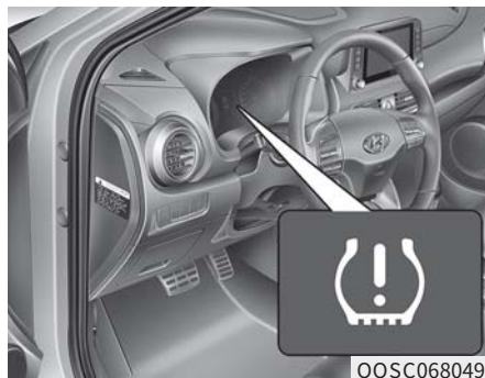
(2) 低压轮胎位置警告灯和轮胎压力低警告灯 (在 LCD 显示器上显示)
