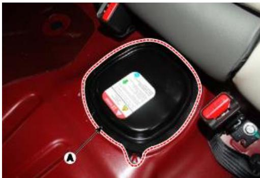
b) 拆卸维修插头
