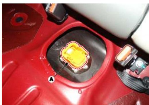
按照下列程序拆卸维修插头：
