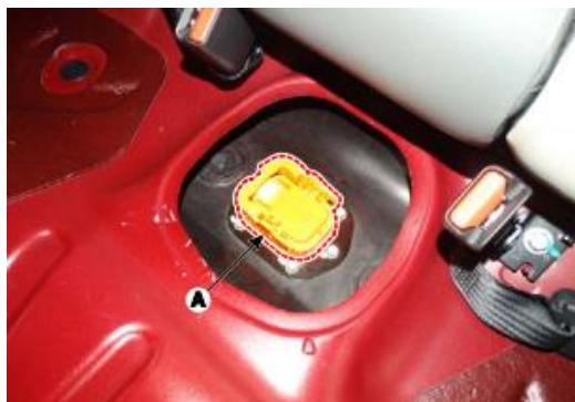
按照下列程序拆卸维修插头:
