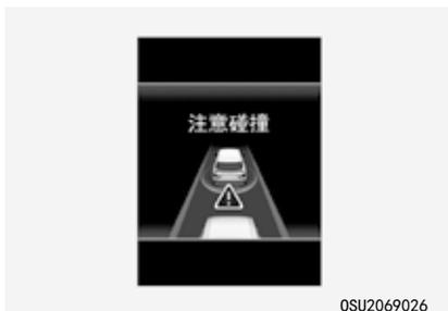
在 LCD 显示器上显示此警告信息，伴随着警报音。另外，发动机管理系统也会介入一些车辆系统，以帮助减速车辆。
