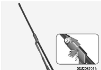
2. 稍微倾斜雨刮器刮片 (1)，按下雨刮器臂上的按钮 (2)，向上滑动雨刮器刮片拆卸它 (3)。
