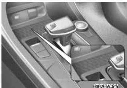
在特定车型中，车辆配备无线手机充电器。
