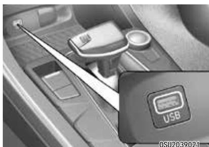
您可使用 USB 数据线在车辆 USB 接口上连接音频设备。
