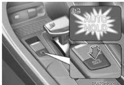
1. 在驾驶席车门、发动机罩关闭状态，踩下制动踏板，然后按下自动驻车 [AUTO HOLD] 开关。白色“自动驻车 (AUTO HOLD)”指示灯亮，系统进入准备就绪状态。
