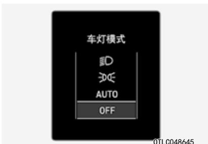
此指示灯显示利用灯光开关控制的当前外部灯控制状态。
