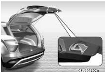
降低后备箱门，然后向下按下直到后备箱门牢固闭锁。一定要在没有按下后备箱门手柄开关的状态下，试探性向上提起后备箱门进行检查，确定后备箱门牢固锁定。
