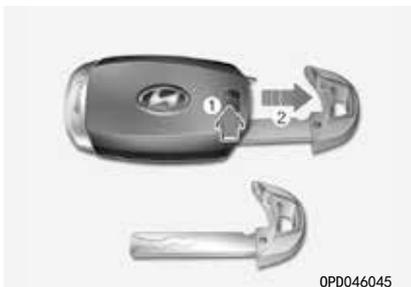
按住释放按钮 (1) 并拔出机械钥匙 (2)。将机械钥匙插入在车门钥匙锁筒内。
