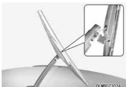
2. 把新雨刮器刮片中央部分插入雨刮器臂内的槽直到伴随着“咔嗒”声定位为止，安装新雨刮器刮片总成。
