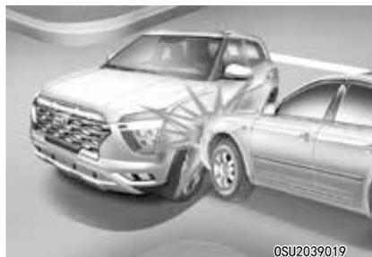
正面空气囊设计为在车辆侧面碰撞中可能不展开。因为在车辆侧面发生碰撞时，由于撞击惯性力的作用，乘员的身体会向碰撞方向移动，因此即使正面空气囊展开也无法提供任何保护。
