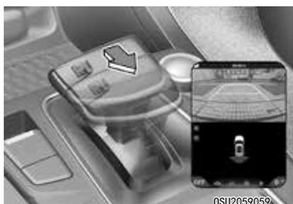
变速杆挂到“R(倒车)”档时，配备驻车引导线的后视镜监控系统启动。
