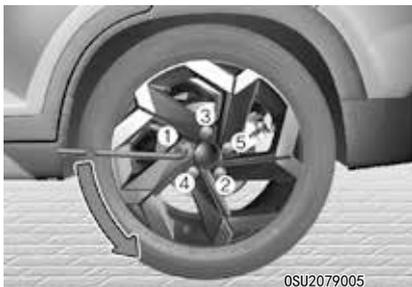
6. 按顺序逆时针方向转动每个车轮螺母 1 圈来松动车轮螺母，但在轮胎离地之前不要拧下螺母。
