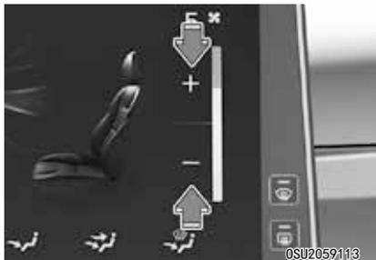
通过按下空调控制界面上的鼓风机速度控制按钮，可把鼓风机速度设定到理想速度。
