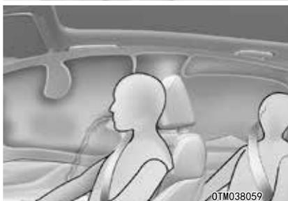
窗帘式空气囊位于前后车门上方车顶纵梁的两侧。
