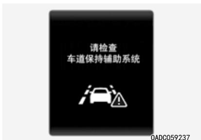
如果系统有故障，将显示此警告信息持续几秒钟。如果故障仍存在，LKA 系统故障警告灯将点亮。
