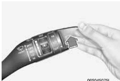
朝远离您的方向推开关杆，后窗喷水并且后雨刮器运转 1-3 周期。喷水器及雨刮器持续工作，直到您释放开关杆为止。
