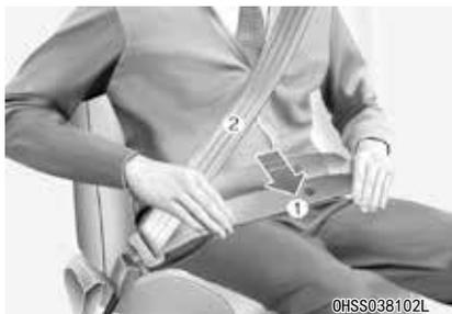
应将胯部安全带 (1) 部分绕过您的臀部，将肩部安全带 (2) 部分绕过您的胸部。
