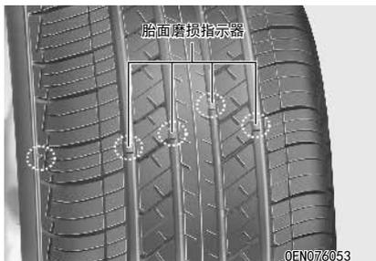
如果轮胎磨损均匀，胎面磨损指示器将作为横过胎面的硬带出现。这表示胎面剩余厚度不足1.6mm(1/16in.)。此时应更换轮胎。不要等到整圈胎面都出现硬带时再更换轮胎。
