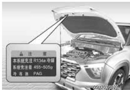
您可以在发动机盖里看到车辆制冷剂标签。
