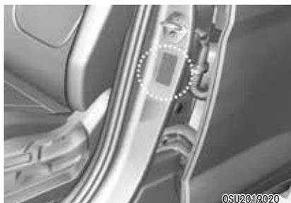
在车辆标签上可以看到所有规格（尺寸与轮胎充气压力）。
