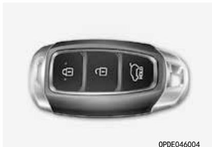
在随身携带智能钥匙的状态下，按下车门外侧手柄上的按钮或按下智能钥匙上的门锁闭锁按钮，可闭锁车门。
