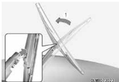
1. 向上提起雨刮器臂，拔出雨刮器刮片总成。
