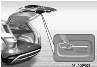
在车辆的后备箱门底部配备了紧急后备箱门安全释放杆。当有人不慎被锁在行李舱内时，可通过下列操作打开后备箱门：
