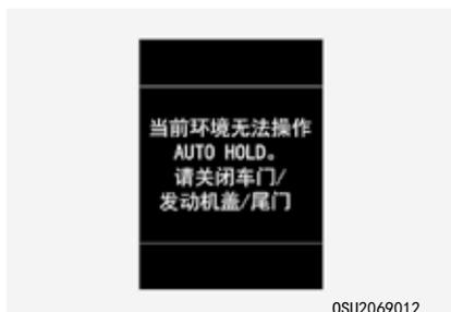
不满足自动驻车条件。关闭车门、发动机罩和后备箱门
