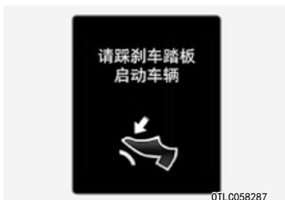
在没有踩下制动踏板的状态下，变速杆从“N(空档)”档挂到“R(倒车)”档、“D(前进)”档或手动换档模式时。此时，在LCD显示器上显示“起步前踩下制动踏板”的警告信息。要激活自动起动功能，请踩下制动踏板。
