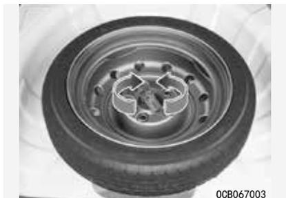
逆时针转动蝶形压紧螺栓，并拆卸备胎。
