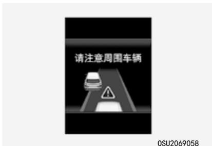
如果前车（车速：小于 30km/h）消失在下一车道，警报声响并且显示“观察周围车辆”信息。踩下制动踏板，调整车速以适应您车前突然出现的车辆或物体。
