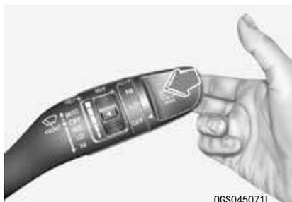
在 OFF 位置，朝您的方向轻拉开关杆，向挡风玻璃喷射清洗液并运转雨刮器 1-3 周期。喷水器及雨刮器持续工作，直到您释放开关杆为止。如果喷水器不工作，可能需要在喷水器液储液箱内添加喷水器液。
