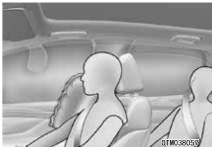
车辆的每个前座椅上都安装了侧面安全气囊。安装它的目的是给驾驶员和前座乘员提供安全带以外的额外保护。
