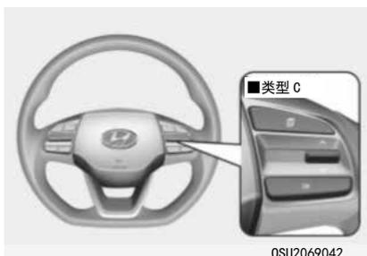
要变换行车电脑模式，拨动方向盘上的“^、v”开关。
