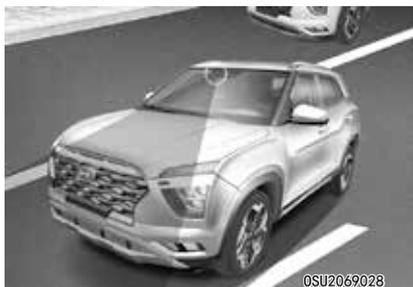
车道保持辅助 (LKA) 系统使用前挡风玻璃上的前视摄像头检测道路车道线，并辅助驾驶员进行转向控制，帮助将车辆保持在本车道上行驶。
