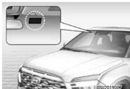
电子标识 (RFID) 标签应粘贴在车辆挡风玻璃内侧的推荐位置，请粘贴在不妨碍驾驶员视线的区域。
