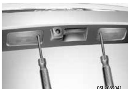
1. 使用十字型螺丝刀拧下透镜固定螺钉。
