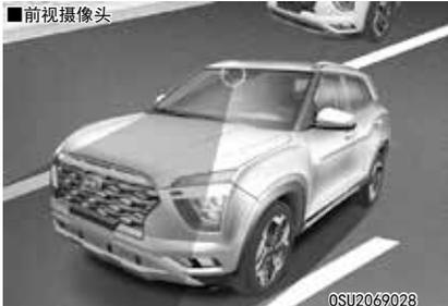
为使 FCA 系统能正常工作，总要确定传感器或传感器盖干净且没有灰尘、雪和碎片。
