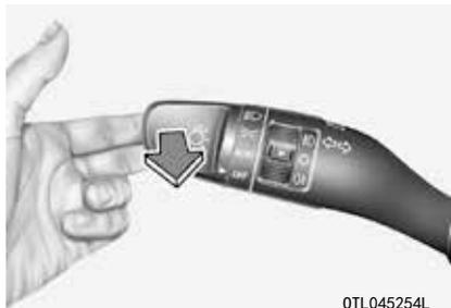
要使大灯远光闪光，可以朝您所在的方向拉灯光控制杆，然后释放。只要朝自己所在的方向拉动并保持灯光控制杆，则远光一直亮。
