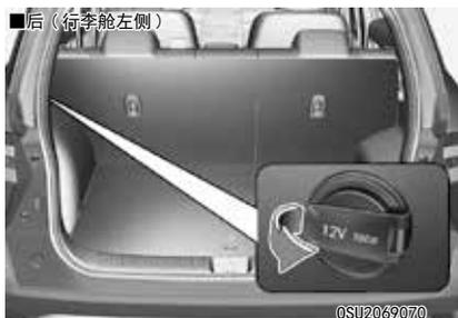
电源插座用于给手机或其它与车上的电气系统一起工作的设备提供电源，发动机运转时此插座可获得120W (瓦特) 以下的电流。
