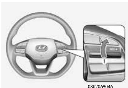
向上推动拨动开关 (1) (RES+)。如果车速超过 30km/h，车辆恢复到预设的巡航控制速度。
