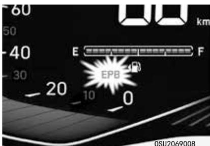
如果 EPB 故障警告灯持续亮、在行驶中亮起或在将发动机起动 / 停止按钮置于 ON 位置时不亮，表示 EPB 系统可能有故障。
