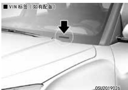
在仪表板顶部附着板件上也有 VIN，从外部透过挡风玻璃可轻易看到这个板件上的号码。
