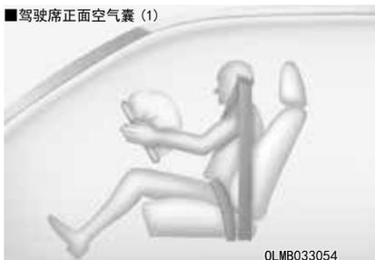
当 SRSCM 检测到车辆正面碰撞严重性达到一定程度时，自动展开正面空气囊。
