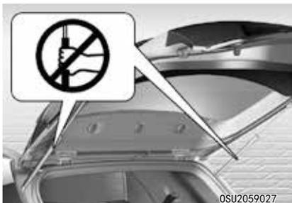
不要抓住后备箱门支撑杆（气体升降器）。否则，可能由于支撑杆部件变形导致车辆损坏，并有发生人身伤害的危险。
