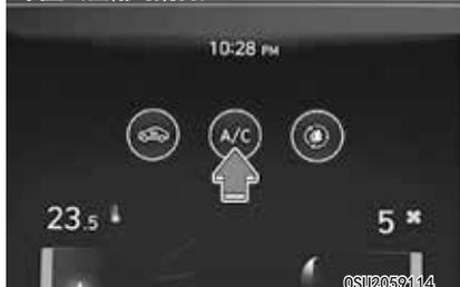
按下空调 (A/C) 按钮可手动打开 (指示灯亮) 和关闭制冷系统。
