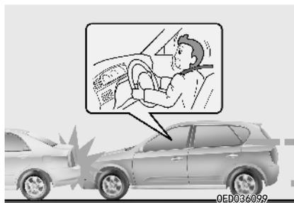
在某些低速碰撞中，空气囊会不展开。空气囊设计为在这些情况中不展开，因为在低速碰撞中，安全带能提供足够的保护，而空气囊不能起到保护作用。
