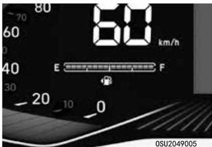
燃油表指示燃油箱中剩余的大约燃油量。
