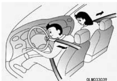
您车辆配备了驾驶席和助手席安全带拉紧器。配备此拉紧器的目的是为了在发生一定程度的正面碰撞事故时确保安全带紧固乘员的身体。当发生正面碰撞事故，其严重性达到一定程度时安全带拉紧器会与气囊一起工作。
