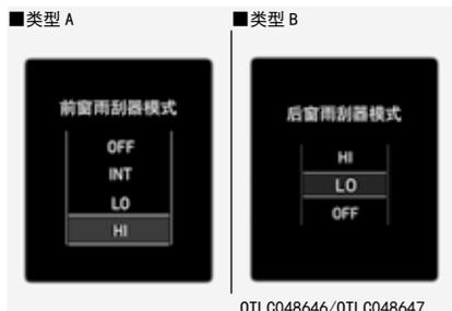
此指示灯显示利用雨刮器开关控制的当前雨刮器控制模式。
