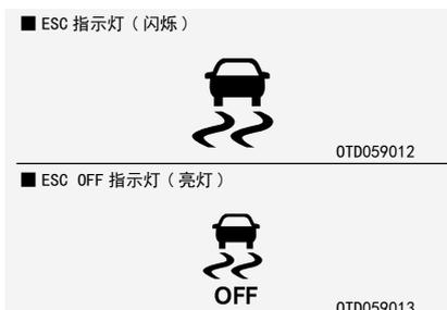
把点火开关置于 ON 位置时, ESC 工作灯亮, 然后在 ESC 系统正常工作时熄灭。
