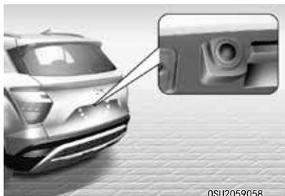
后视镜系统是驾驶辅助系统，在驻车过程中通过 AVN 系统显示器显示车辆后方区域，以辅助驾驶车辆。更详细信息请参考您车辆单独提供的资讯娱乐系统手册。
