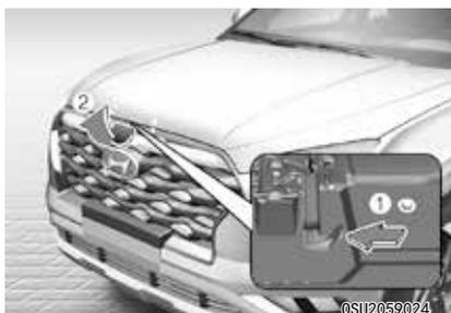
3. 在车辆前方，稍微抬起发动机罩，并向上抬起内侧发动机罩中央的第二挂钩 (1)，并举升发动机罩 (2)。发动机罩打开至半程位置后会自动完全打开。
