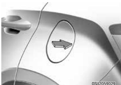
必须在车内拉起燃油加油口门释放杆打开燃油加油口门。
