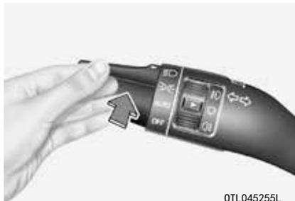
要打开大灯远光，应向远离您的方向推动灯光控制杆。释放控制杆时，会返回到原始位置。
