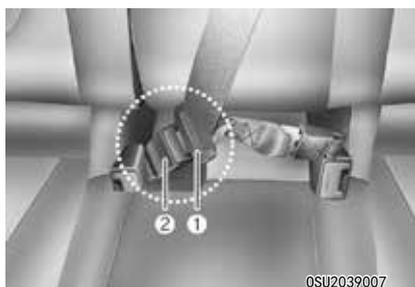
1. 将卡扣 (1) 插入扣环 (2) 直到发出一声“咔嚓”声响时，表示卡扣锁入到扣环中。确定安全带没有扭结。
