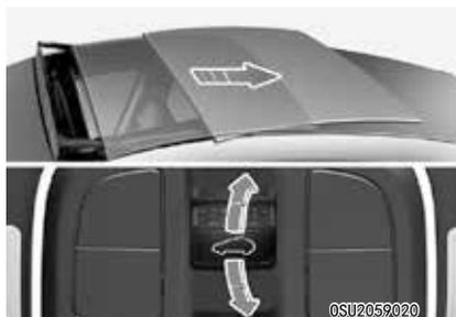
将天窗控制杆向后拉动超过第一止动位置，遮光板滑动完全打开后，天窗玻璃滑动完全打开。
