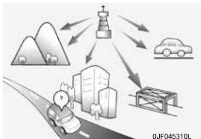
FM广播信号是以高频率传送的，它不能弯曲地追随地球曲面。因此，FM广播信号通常在离信号发射塔较近的地方就开始时强时弱。同样，FM信号易受高楼、高山或其它阻塞物的影响。这些原因可导致声音不清晰，使您认为您的收音机存在故障。下列情况属正常现象，并不代表收音机发生故障：
