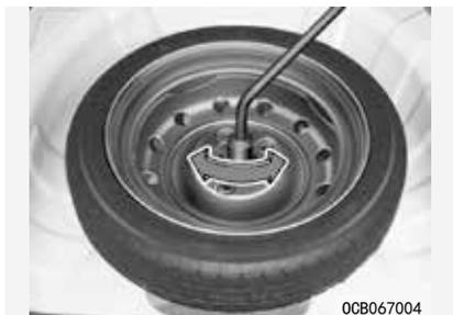
如果用手难以拧下备胎蝶形压紧螺栓，使用车轮螺母扳手可轻易拧下此螺栓。
