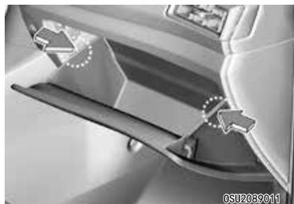
2. 如图所示，按压手套箱的两侧。将手套箱止动销从固定位置分离，从而拿出手套箱。
