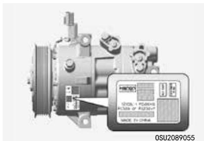
压缩机标签通知您车辆配备的压缩机类型如型号、供应商部件号、生产编号、制冷剂 (1) 和制冷剂润滑油 (2)。
