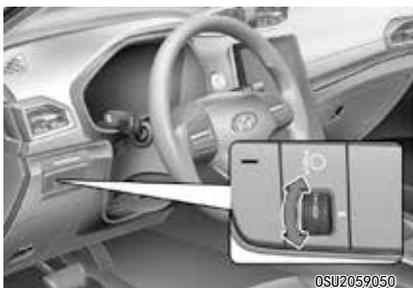
要根据乘员数及行李区的负载重量调整大灯水平光束高度, 旋转大灯水平光束高度调整开关。
