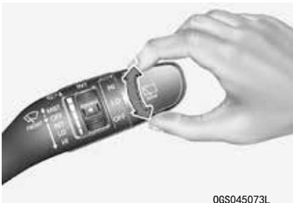
后窗雨刮器和喷水器开关位于雨刮器和喷水器开关杆的末端。将开关转至理想位置，操作后雨刮器和喷水器。
