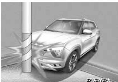
如果车辆与某些物体，如电线杆或树木等发生碰撞，在这种碰撞中，碰撞点集中在某个位置，并且碰撞能量被车辆结构吸收，所以空气囊可能不展开。
