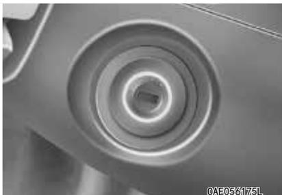
点火开关不在 ON 位置时，无论何时打开前车门，点火开关照明灯都会亮，为您提供便利。此灯在将点火开关置于 ON 时立即熄灭或在关闭车门 30 秒钟后熄灭。（如有配备）
