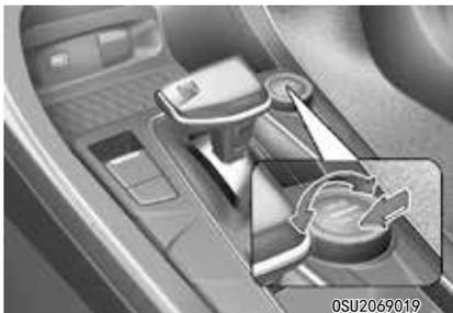
按下“驾驶 / 牵引力”模式按钮时，驾驶模式从驾驶控制转换到牵引力控制模式。然后转动“驾驶 / 牵引力”模式旋钮选择雪地、泥路或沙地模式。如果再次按下“驾驶 / 牵引力”模式按钮，驾驶模式从牵引力控制转换到驾驶控制模式。
