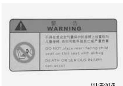
为了警告乘员安全气囊系统的潜在危险性，附着了安全气囊警告标签。
