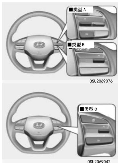
使用控制按钮可变换 LCD 显示器显示模式。
