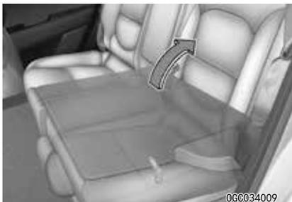
4. 要使用后座椅，抓住座椅靠背提起并向上推动，牢固推动座椅靠背直到发出咔嚓声锁定定位。确定座椅靠背牢固锁定。
