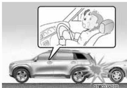
正面空气囊设计为在车辆后部发生碰撞时不展开。因为在车辆后部发生碰撞时，在撞击惯性力的作用下，乘员的身体会向后移动，因此即使正面空气囊展开也不能提供任何保护。
