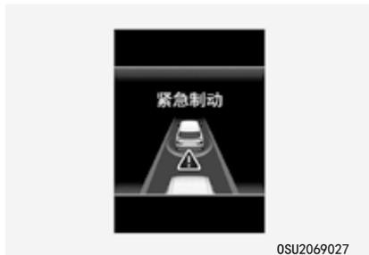
在 LCD 显示器上显示警告信息，伴随着警报音。
