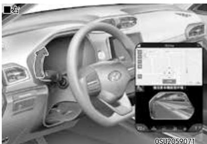
当左或右转向信号 ON 时，后侧方盲区监控系统在 AVN 显示器上显示您车辆的左侧或右侧后侧方盲区。当您变更车道时，此功能帮助您安全驾驶。
