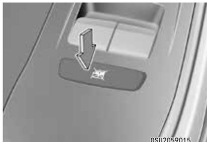
驾驶员可以通过按下电动门窗锁止开关来停用后乘员车门上的电动门窗开关。
