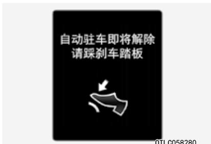
自动驻车即将解除，请踩下制动踏板
