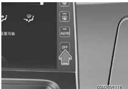
按下 OFF 按钮即可关闭空调控制系统。只要点火开关置于“ON”位置，仍能操纵通风模式和内外气选择控制按钮。
