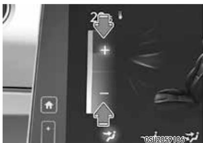
2. 按动温度按钮，在屏幕上设置所需的温度。设到最低温度设置时，空调系统会持续工作。
