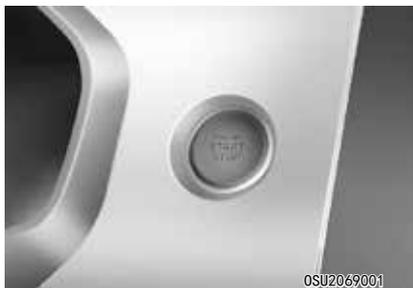
无论何时打开前车门，发动机启动 / 停止按钮照明灯亮，车门关闭 30 秒钟之后照明灯 OFF（如有配备）。
