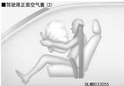
空气囊展开时，直接模压在装饰盖内的撕裂接缝会在空气囊的膨胀压力作用下被分离。装饰盖进一步打开，空气囊膨出完全展开。
