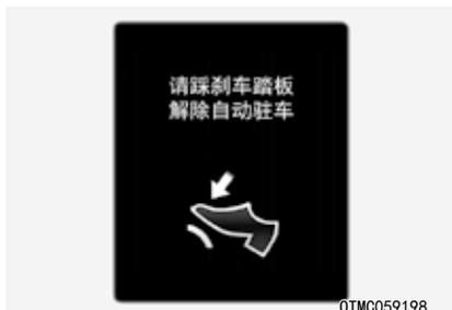
请踩下制动踏板，解除自动驻车。当按下自动驻车 [AUTO HOLD] 开关解除自动驻车功能时，如果没有踩下制动踏板，就会发出警报声，并显示此警告信息。
