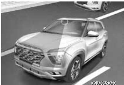
车道跟踪辅助（LFA）系统使用前挡风玻璃上的前视摄像头检测道路车道线，并辅助驾驶员进行转向控制，帮助将车辆保持在本车道上。
