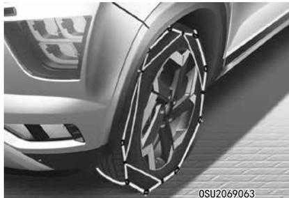
由于子午线轮胎侧围比其它类型的轮胎薄，如果在其上装配某些类型的防滑链，可能会损坏轮胎。因此使用推荐的防滑轮胎代替防滑链。不要在配备铝制车轮的车辆上安装轮胎防滑链；如果不可避免，使用导线防滑链。如果必须使用防滑链，使用北京现代正品配件并在审阅防滑链提供的说明书后，安装轮胎防滑链。由于防滑链使用不当而导致的车辆损坏，不属于车辆制造商的保修范围。
