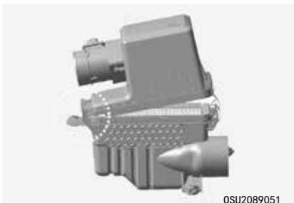
4. 装配空气滤清器盖后，将盖插入铰链并将卡扣卡入。
