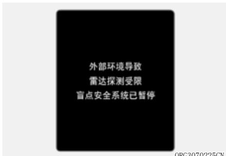
当后侧方盲区雷达传感器或后保险杠的传感器装配部位被雨雪、任何异物等覆盖时，或者安装了挂车或托架时，均会降低传感器的检测性能，而且可能导致后侧方盲区防撞辅助(BCA)功能失效或临时受到限制。
