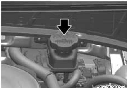
定期检查储油罐内的油量。油量应在储油罐侧最大(MAX)与最小(MIN)标记之间。
