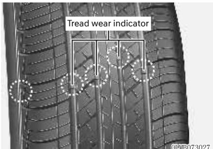
如果轮胎磨损严重而且均匀，会露出横过胎面的实心带式磨损指示器。这表示胎面剩余厚度不足1.6mm(1/16in.)。此时应更换轮胎。
