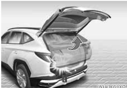
电动后备箱门在电动打开和关闭过程中，如果电动后备箱门系统检测到任何阻力，电动后备箱门就会停止，并自动反向操作。
