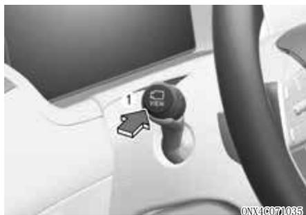
全景影像可通过安装在车辆上的摄像头帮助驻车, 并通过信息娱乐系统显示屏显示车辆周围图像。
