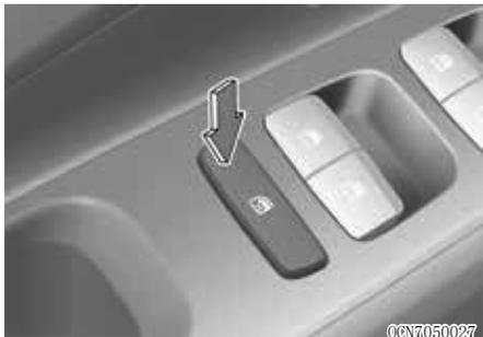
驾驶员按下电动门窗锁止开关，可以停用后车门上的电动门窗开关。
