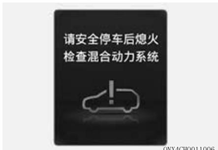
当混合动力控制系统存在故障时，就会显示此警告信息。此时会发出警报声，直到排除故障为止。当显示此警告信息时，就会限制车辆的驾驶操作。
