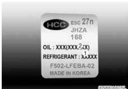
压缩机标签告知您车辆配备的压缩机类型，如型号、供应商配件号、生产编号、制冷剂(1)和压缩机润滑油(2)规格等。
