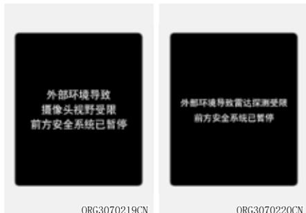
当前挡风玻璃的前视摄像头安装部位、前雷达盖或传感器被雨雪、任何异物覆盖时，会降低传感器的检测性能，并可能导致正面防撞辅助(FCA)功能失效或临时受到限制。
