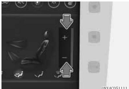
在暖风&空调控制系统设置显示屏上，按动鼓风机速度控制图标按键，可以调整鼓风机速度至理想的速度。
