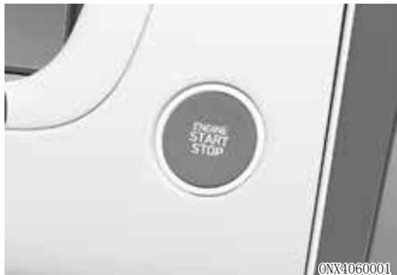
当打开前车门时，发动机起动/停止按钮照明灯亮。前车门关闭30秒钟后，照明灯就会熄灭。(如有配备)
