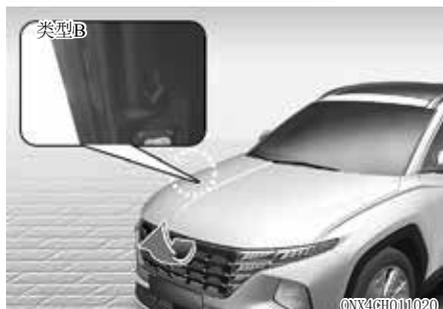
使用车辆识别码 (VIN) 可登记您的车辆并处理有关车辆所有权的所有法律事务等。车辆识别码 (VIN) 冲印在发动机室框架和发动机的后部。
