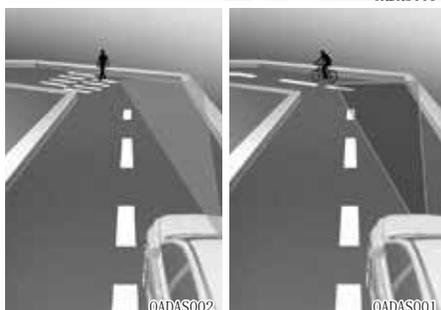
车辆在弯曲道路上行驶时，正面防撞辅助(FCA)功能传感器的检测能力会受到限制，可能检测不到转弯道路上的前方行人、车辆或骑车人。这可能导致在必要时不发出警报、不采取紧急制动辅助控制措施。
