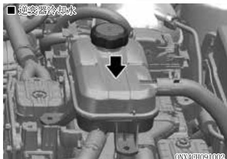
如果冷却水量不足，填加根据适当冷却水混合比例选择的防冻液，使冷却水量达到最大(MAX)标记，请勿填充过量。
