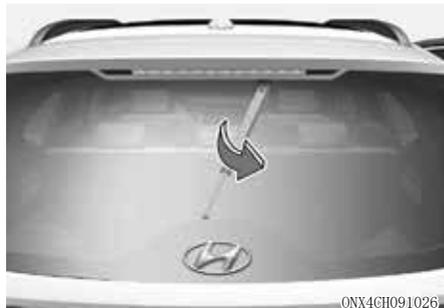
1. 点火开关[OFF]后20秒钟内，将雨刮器控制杆移到刮雾(MIST)位置持续2秒钟以上时间，直至雨刮器下移至底部中间部分。
