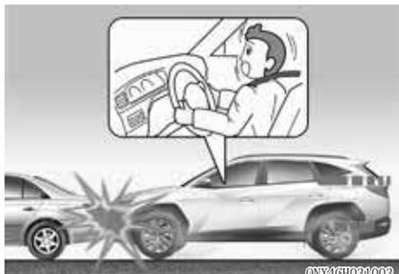
在某些低速碰撞中，安全气囊可能不展开。安全气囊设计为在这些情况下不展开。因为在低速碰撞中，安全带能提供足够的保护，而即使安全气囊展开也不能提供额外保护。
