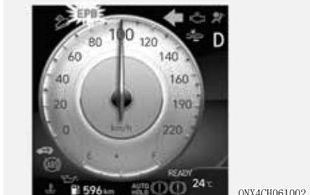
如果 [EPB] 警告灯持续亮，或者在行驶中亮，或者在将点火开关转至 [ON] 位置时不亮，表示电控驻车制动器 (EPB) 系统可能存在故障。
