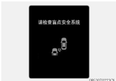
后侧方盲区防撞辅助(BCA)功能不能正常运行时，就会在仪表盘上显示“请检查后侧方盲区安全系统”的警告信息持续几秒钟，并且仪表盘上的主(▲)警告灯亮。在此状态下，我们建议您请北京现代授权经销商检查系统。
