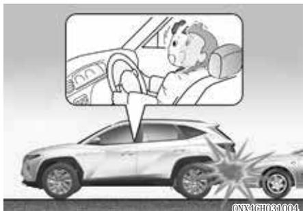
正面安全气囊设计为在车辆后部发生碰撞时不展开。因为在车辆后部发生碰撞时，在撞击惯性力的作用下，乘员的身体会向后移动，因此即使正面安全气囊展开也不能提供任何保护。
