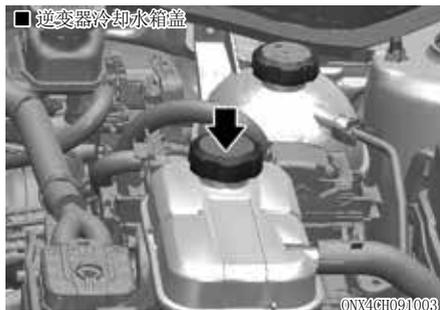
检查所有冷却系统软管和加热器软管的连接部位和状态。更换膨胀或变质的软管。
