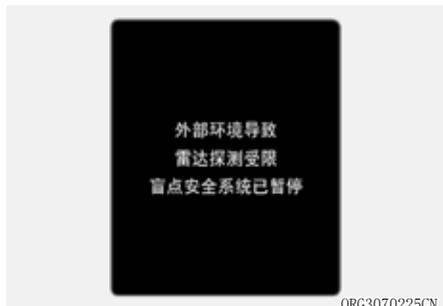
当后方盲区雷达传感器或后保险杠的传感器装配部位被雨雪、任何异物等覆盖时，或者安装了挂车或托架时，均会降低传感器的检测性能，而且可能导致安全下车预警(SEW)功能失效或临时受到限制。
