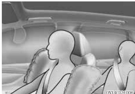
车辆的每个前排座椅上都安装了侧面空气囊。
