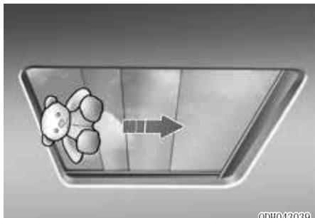
在天窗玻璃自动关闭期间，如果检测到障碍物的阻力，天窗玻璃会反向操作，然后停在某个位置，以便清除障碍物。
