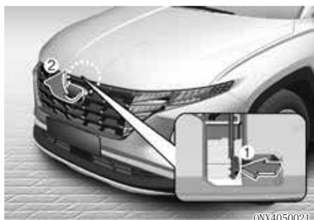
3. 在车辆前方，稍微抬起发动机罩，并向上抬起位于发动机罩中央内侧位置的副挂钩(1)，然后抬起发动机罩(2)。
