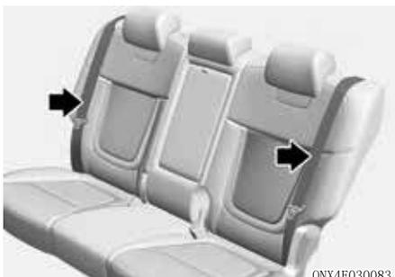
3. 向下折叠座椅靠背时，将座椅安全带束带置于朝向外侧的位置，以防座椅安全带系统干扰座椅靠背的折叠操作。
