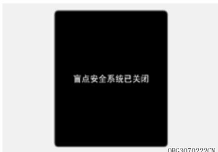
在后侧方盲区防撞辅助(BCA)功能停用状态下,如果重新启动发动机,就会在仪表盘显示屏上显示“后侧方盲区安全系统关闭”的警告信息。
