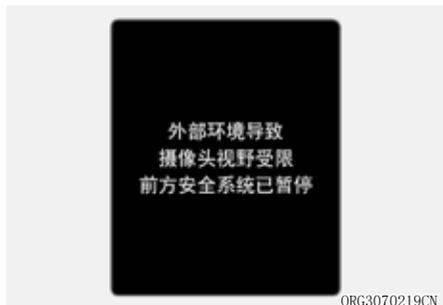
如果在前视摄像头装配位置的挡风玻璃或传感器被雨雪、任何异物覆盖，会降低传感器的检测性能，而且可能导致正面防撞辅助(FCA)功能失效或临时受到限制。
