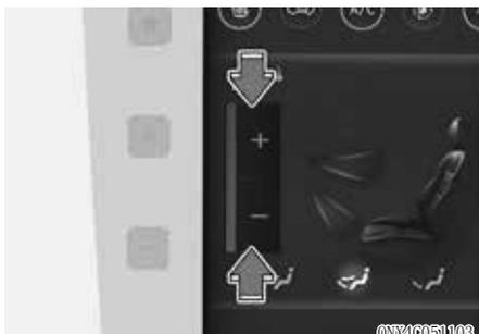
2. 在显示屏上，按动“+”或“-”图标按钮，设置理想的室内温度。将室内温度设置至最低温度 (Lo) 时，制冷系统会持续运行。
