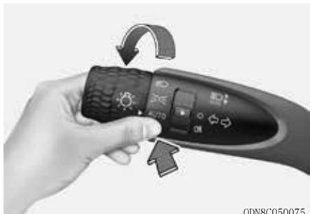
大灯远光辅助 (HBA) 功能根据迎面驶来车辆的灯光亮度和道路条件自动调整大灯模式 (在远光与近光之间转换)。
