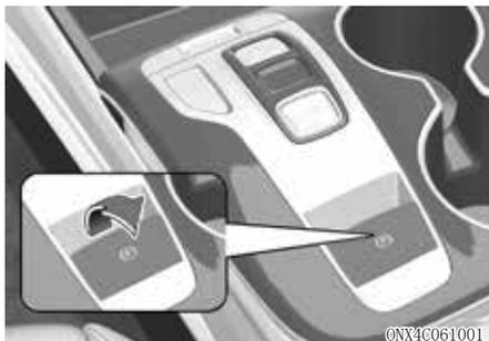
要啮合电控驻车制动器 (EPB)，执行下列操作：
