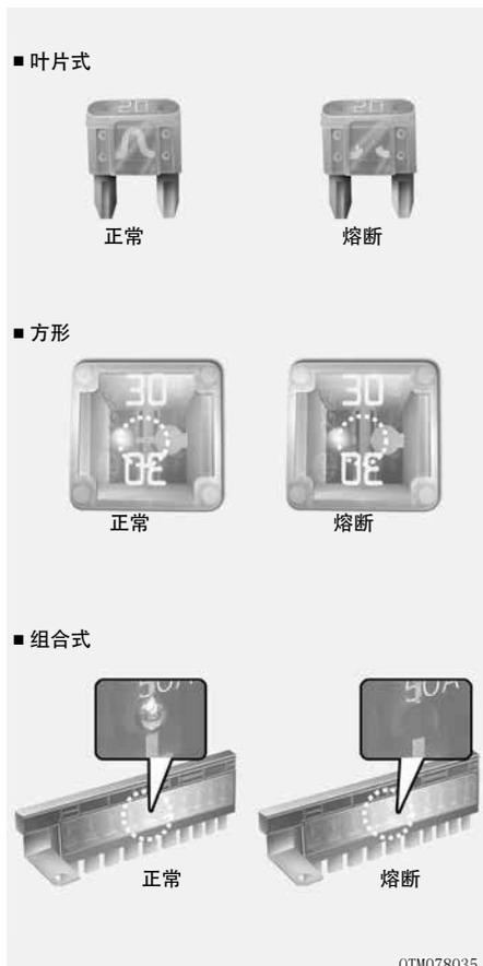
使用保险丝保护车辆的电气系统，避免电气系统因电流过载而损坏。
