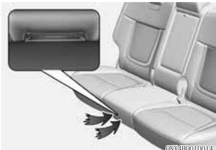
混合动力蓄电池冷却空气管道的进口位于后座椅底部中央。通过冷却管道冷却混合动力蓄电池。如果混合动力蓄电池冷却管道被堵塞，会导致混合动力蓄电池温度过高。
