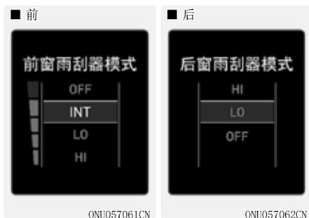
此模式显示由雨刮器控制系统控制的雨刮器运转模式。
