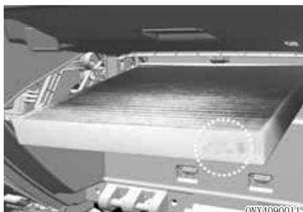
**箭头符号(↓)朝下，正确方向安装新品空调滤清器，以防发出噪声，并提高滤清器效果。**
