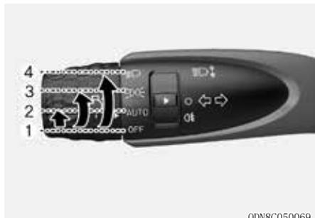
要控制灯光，转动灯光控制杆末端的控制旋钮到下列位置中的一个：
