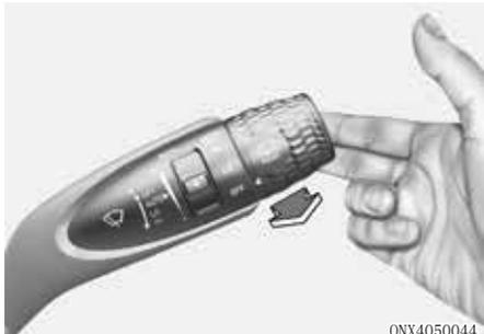
在喷水器[OFF] (0)位置，向后拉动雨刮器控制杆并释放时，喷水器向挡风玻璃喷射清洗液，并且雨刮器运转1~3周。如果雨刮器控制杆保持在此位置，喷水器持续喷水，而且雨刮器持续运转，直到释放雨刮器控制杆为止。如果喷水器不运转，可能是挡风玻璃清洗液储液箱内的清洗液不足所致，需要添加清洗液。
