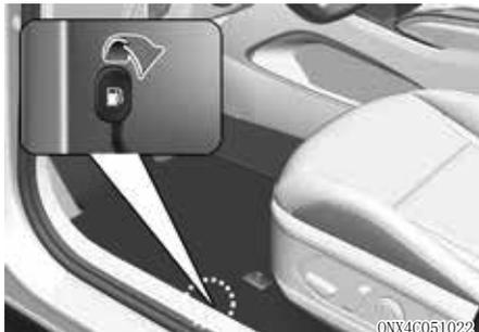
要打开燃油加油口门，拉起车内的燃油加油口门释放杆。
