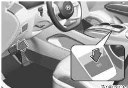
要释放电控驻车制动器 (EPB)，在下列条件下，按下 [EPB] 开关：
