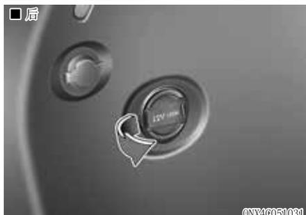
电源插座用于给手机或其它与车上的电气系统一起工作的设备提供电源。
