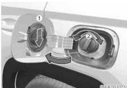
3. 向外拉出燃油加油口门(1)完全打开。
