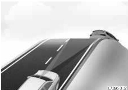
在上坡/下坡道路上行驶时，智能巡航控制(SCC)功能可能检测不到本车道内的前方车辆，这可能会导致本车辆加速到设定的巡航控制速度。此外，如果突然检测到前方车辆，车辆可能会紧急减速。
