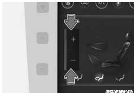
在显示屏上，按动温度设置图标按键，可以设置理想的室内温度。按动(+)图标按键时，温度设置值就会增大，而按动(-)图标按键时，温度设置值就会降低。
