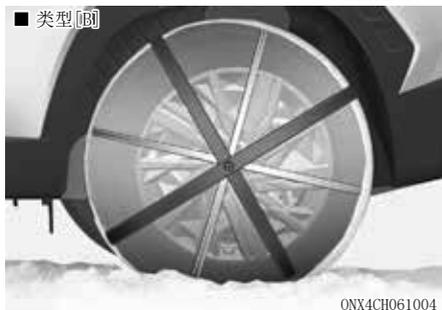
由于某些子午线轮胎侧围比其它类型的轮胎薄，如果在其上装配某些类型的防滑链，可能会损坏轮胎。因此使用推荐的防滑轮胎代替防滑链。不要在配备铝制车轮的车辆上安装轮胎防滑链；如果不可避免，使用线式防滑链。
