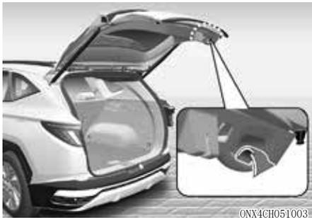
降低后备箱门至关闭位置，然后按压后备箱门，直到牢固闭锁为止。一定要在没有按下后备箱门手柄按钮的状态下，试着向上提起后备箱门进行检查，确定后备箱门牢固闭锁。
