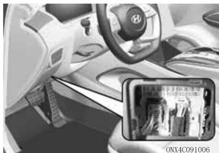
使用北京现代授权诊断设备可从 ECU 上找到 VIN。将诊断设备连接到室内保险丝盒上的 OBD 连接器上, 有关更详细信息请联络北京现代授权经销商。
