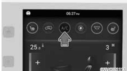
按下空调 (A/C) 图标按键，可以手动启动 (指示灯亮) 或关闭 (指示灯熄灭) 制冷系统。
