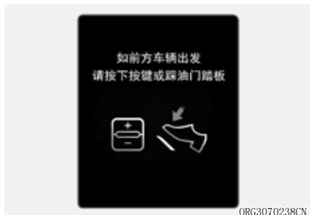
当公路驾驶辅助(HDA)功能处于运行状态时，如果前方车辆停止，本车辆也会停止。同样，如果在停车后30秒钟内前方车辆开始移动，本车辆也起步。此外，在车辆停车超过30秒钟时，就会在仪表盘上显示“使用开关或加速踏板加速”的警告信息。此时，踩下加速踏板或操作拨动开关(+)、(-)或按下II $\odot$ 开关驾车起步行驶。
