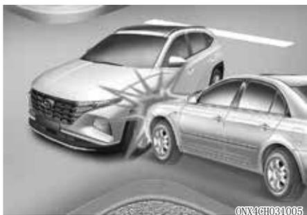
正面安全气囊设计为在车辆侧面碰撞中不展开。因为在车辆发生侧面碰撞时，由于撞击惯性力的作用，乘员的身体会向碰撞方向移动，因此即使正面安全气囊展开也无法提供任何保护。
