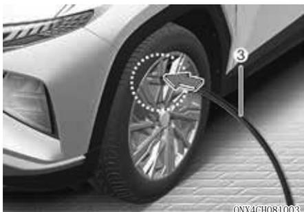
14. 将压缩机的软管(3)连接到轮胎充气阀上。
