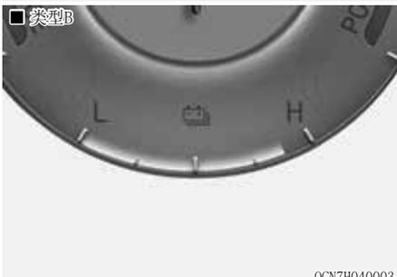
此充电状态(SOC)表指示混合动力蓄电池的剩余电量。如果充电状态(SOC)接近“L(低)”位置，车辆自动起动发动机给蓄电池充电。
