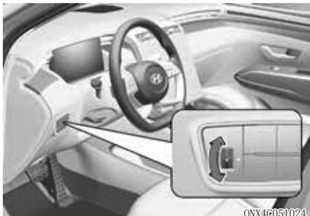
根据乘员数及行李箱内负载重量，转动大灯水平调整旋钮，调整大灯水平光束角度。
