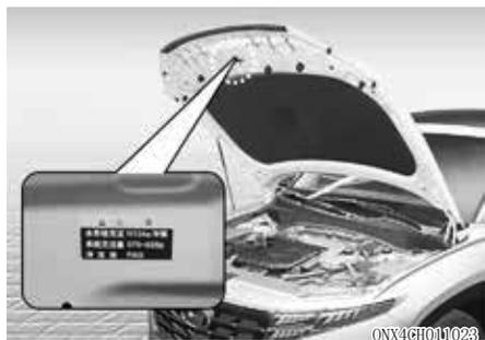
制冷剂标签上提供有制冷剂类型和制冷剂量信息。
