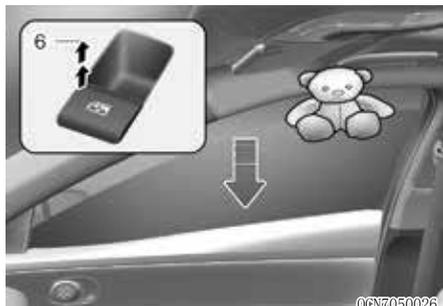
如果门窗在自动关闭期间检测到障碍物的阻力, 门窗会停止移动, 并自动下降约30cm(12in.), 以便清除障碍物。
