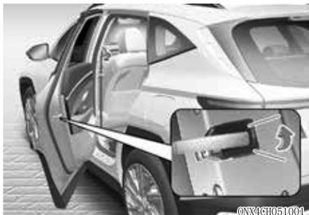
如果门锁不能使用电动门锁操纵开关进行电动操作，唯一的解决方法是将机械钥匙插入至外侧手柄钥匙锁筒孔内闭锁车门。
