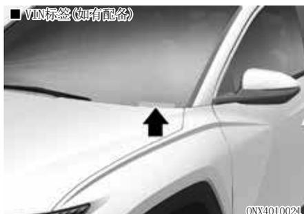
在仪表板顶部附着板件上也刻印有车辆识别码 (VIN)。从外部透过挡风玻璃可轻易看到在此板件上刻印的车辆识别码 (VIN)。
