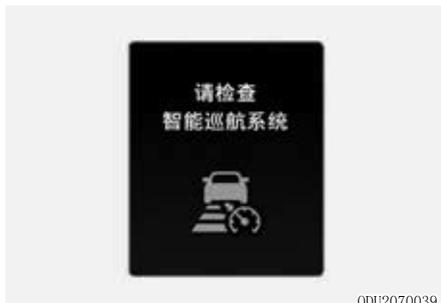
智能巡航控制(SCC)功能不能正常运行时，就会在仪表盘显示屏上显示“检查智能巡航控制(SCC)功能”的警告信息，且仪表盘上的△警告灯亮。在此状态下，我们建议您请北京现代授权经销商检查系统。
