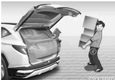
配备智能钥匙的车辆，利用智能后备箱门系统在没有手动操作的状态下，可以自动打开后备箱门。
