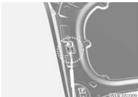
5. 用支撑杆(3)支撑打开的发动机罩。
