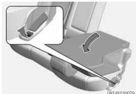
4. 将安全带束带从导环(1)中拔出，然后提起座椅靠背折叠控制杆(2)，并向下方折叠座椅靠背。
