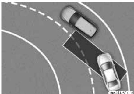
在弯曲道路上行驶时，后侧方盲区防撞辅助(BCA)功能可能不能正常进行控制。在此条件下，此功能可能会识别到相同车道内的车辆。
