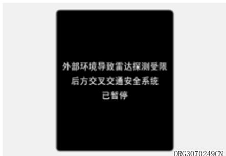
当后侧方盲区雷达传感器或后保险杠的传感器装配部位被雨雪、任何异物等覆盖时，或者安装了挂车或托架时，均会降低传感器的检测性能，而且可能导致倒车侧面防撞辅助(RCCA)功能失效或临时受到限制。
