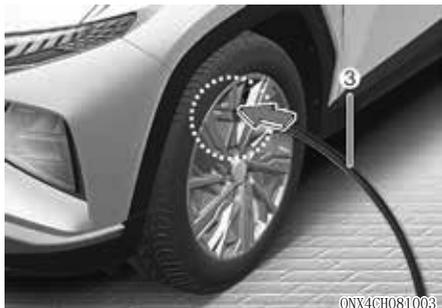
2. 将压缩机的软管(3)连接到轮胎充气阀上。
