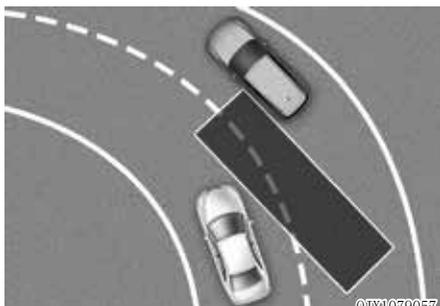
在弯曲道路上行驶时，后侧方盲区防撞辅助(BCA)功能可能不能正常进行控制。在此条件下，此功能可能无法检测到相邻车道内的目标车辆。
