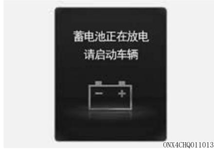
将发动机启动/停止按钮置于[ACC]或[ON]位置，而暂时还没有启动发动机时，可能导致蓄电池过度放电。因此，请启动发动机，以防12V蓄电池过度放电。
