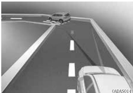
在弯曲道路上行驶时，智能巡航控制(SCC)功能可能检测不到在相同车道内的前方车辆，这可能会导致车辆加速到设定的巡航控制速度。此外，如果突然检测到前方车辆，车辆可能会紧急减速。
