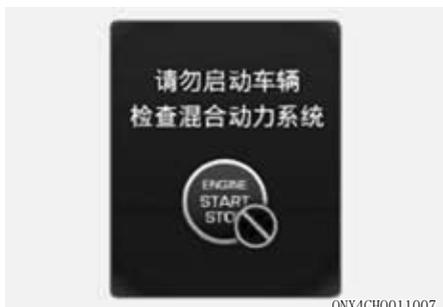
当混合动力蓄电池电能不足(SOC)时，就会显示此警告信息。此时会发出警报声，直到排除故障为止。当显示此警告信息时，就会限制车辆的驾驶操作。
