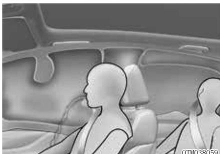
窗帘式空气囊位于车顶两侧的前/后车门上方的车顶纵梁上。
