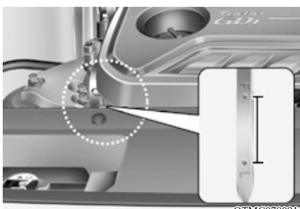
6. 再拉出油尺检查机油量，机油量应在[F(上)]与[L(下)]标记之间。
