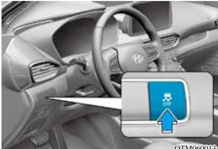
电子稳定控制(ESC)功能在车辆转弯过程中辅助控制稳定车辆。
