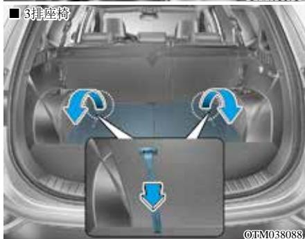
5. 要使用后座椅，向上拉起折叠/展开控制杆或拉动座椅靠背折叠/展开控制带，并向后提起座椅靠背。
