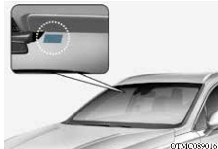
电子标识(RFID)标签应粘贴在车辆挡风玻璃内侧的推荐位置。请确保粘贴的位置不妨碍驾驶员的视线。
