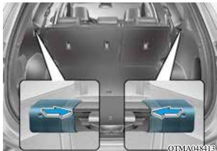
1. 将行李物品安全屏滚筒的一端向内侧推动，以压缩弹簧机构，并从车辆上脱开行李物品安全屏滚筒。
