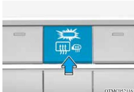
发动机运转时，除霜器加热后窗，除去后窗内外的结霜、结雾和薄冰。
