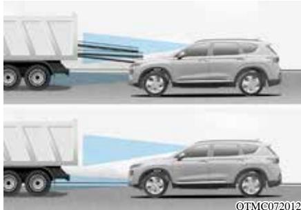
如果前方车辆装载有朝后伸出车厢的长货物，或者前方车辆有较高的离地高度，一定要对前方车辆保持高度谨慎。正面防撞辅助(FCA)功能可能无法检测出从前方车辆车厢中延伸出来的货物。因此，驾驶员必须正确操控车辆与最后的物体保持安全制动距离，并在必要时踩下制动踏板减速，以保持安全车距。
