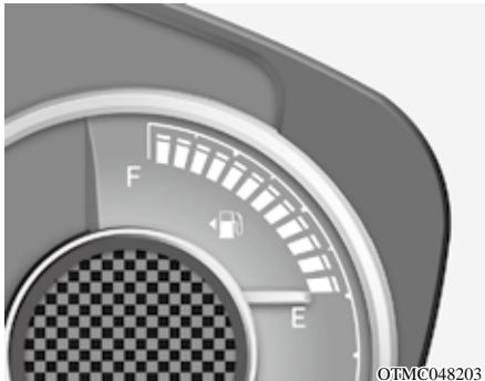
燃油表指示燃油箱中剩余的大约燃油量。
