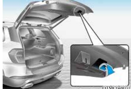
降低后备箱门至最大位置，然后按压后备箱门直至牢固闭锁。一定要在没有按下后备箱门手柄按钮的状态，试着向上提起后备箱门检查是否牢固闭锁。
