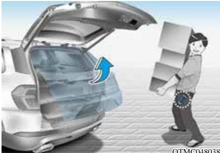
配备智能钥匙的车辆，利用智能后备箱门功能在没有任何手动操作状态打开后备箱门。
