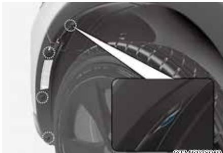
2. 拆卸前轮罩固定卡扣(轮罩：4个，前保险杠底部：3个)。
