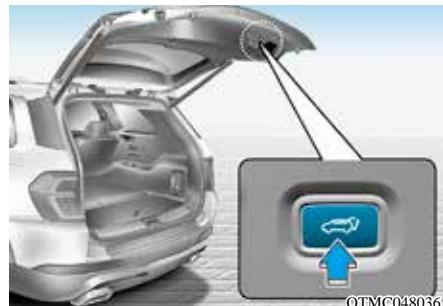
电动后备箱门打开/关闭按钮(电动后备箱门内侧)
