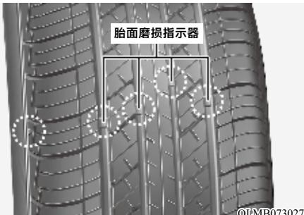
如果轮胎磨损均匀，胎面磨损指示器将作为横过胎面的硬带出现。这表示胎面剩余厚度不足1.6毫米。此时应更换轮胎。
