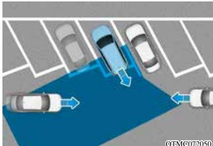
从斜向停车位倒车驶出时，后方交叉碰撞预警(RCCW)功能可能会受到限制。在此状态下，此功能可能无法检测到从左后侧面/右后侧面驶近的目标车辆，从而在需要时不会向驾驶员发出碰撞危险预警。
