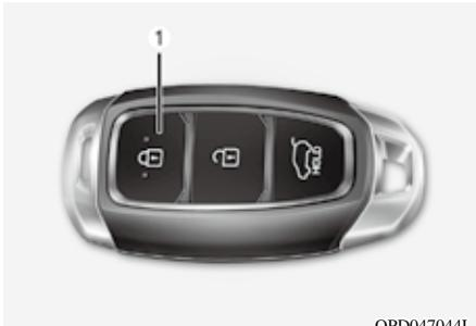
在发动机关闭状态，按住智能钥匙上的门锁闭锁按钮3秒钟以上，可以控制门窗移动。按住门锁闭锁按钮时，门窗上升，释放门锁闭锁按钮时，门窗停止移动。门窗完全关闭时，危险警告灯闪烁3次。
