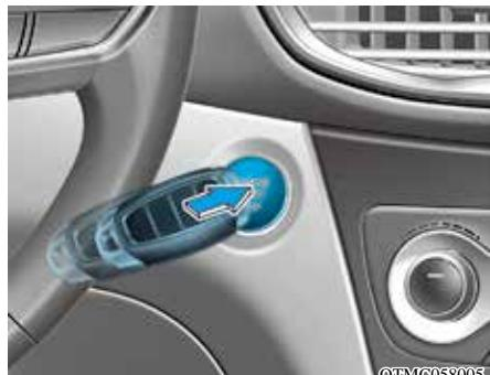
如果智能钥匙电池电量不足或智能钥匙不能正常工作，如上图所示，用智能钥匙按下发动机起动/停止按钮，以此可以起动发动机。
