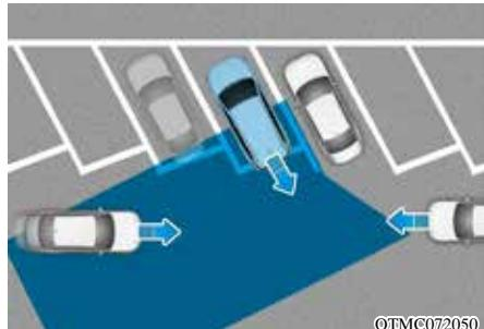
从斜向停车位倒车驶出时，后方交叉防撞辅助(RCCA)功能可能会受到限制。在此状态下，此功能可能无法检测到从左后侧面/右后侧面驶近的目标车辆，从而在需要时不会向驾驶员发出碰撞危险预警，或者不能主动采取制动控制措施。
