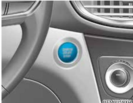
当打开前车门时，发动机起动/停止按钮照明灯亮。当关闭前车门时，照明灯在30秒钟后熄灭。(如有配备)
