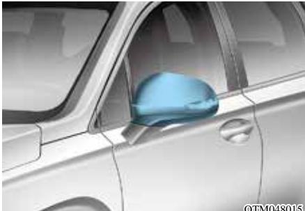
您车辆配备了左侧和右侧外后视镜。可以利用外后视镜调整开关远程调整外后视镜的位置。在进入自动洗车机或狭窄街道时，可以折叠外后视镜，以免车辆损坏。
