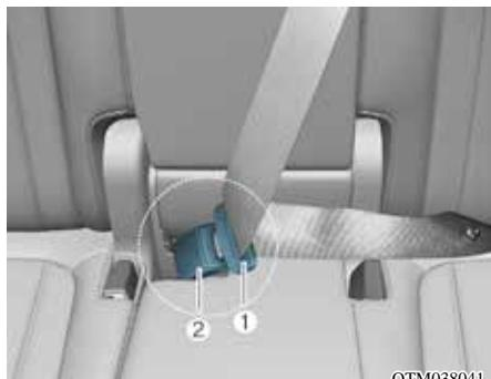
1. 将卡扣(1)插入扣环(2)直到发出一声“咔嗒”声响时，表示卡扣锁入到扣环中。确定安全带束带没有扭结。
