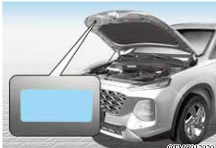
制冷剂标签上提供有制冷剂类型和制冷剂容量信息。
