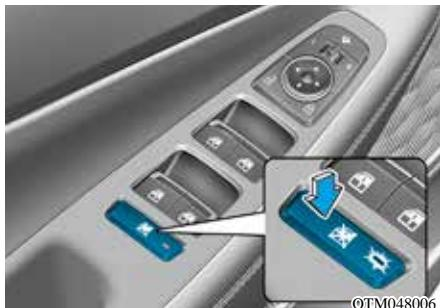
驾驶员可以通过按下电动门窗锁止开关来停用后车门上的电动门窗控制开关。
