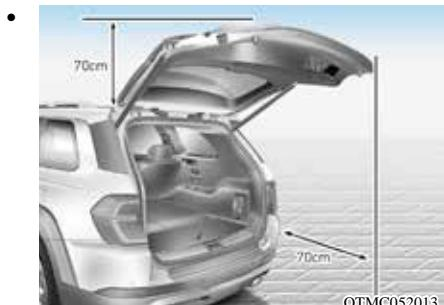
在操作电动后备箱门或智能后备箱门之前，检查和确认在其移动路径上没有任何人或物体。电动后备箱门移动时碰撞人员或物体，可能会导致严重人身伤害或车辆、物品损坏(如墙壁、天花板、车辆等)。
