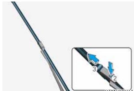
2. 稍微倾斜雨刮器片(1)，并按下雨刮器臂上的锁片(2)，然后向上滑动雨刮器片将其卸下(3)。
