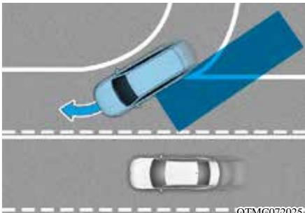
在并道/分岔道口上行驶时，盲点碰撞预警(BCW)功能可能不能正常运行。在此状态下，此功能可能无法检测到相邻车道内的目标车辆。
