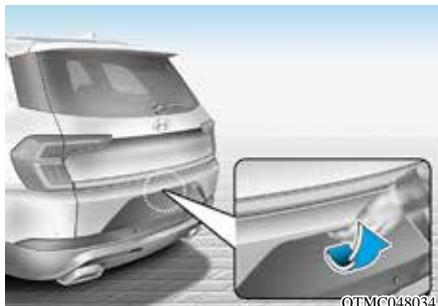
电动后备箱门打开/关闭按钮(电动后备箱门外侧)
