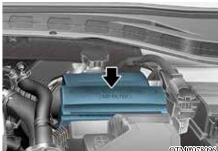
使用压缩空气吹净空气滤清器芯，以便检查。
