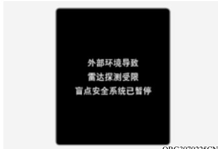
当后侧面雷达传感器或后保险杠的传感器周围被积雪、雨水或安装的挂车、挂架等遮挡时，会降低雷达传感器的检测性能，这会导致安全下车预警(SEW)功能暂停或关闭。
