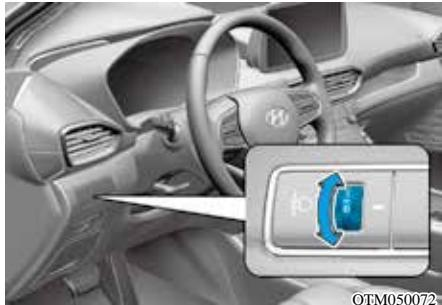
要根据乘员数及行李区的负载重量调整大灯水平光束角度，转动大灯水平调整开关。
