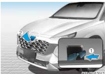
3. 在车辆前方，稍微抬起机舱盖，并向上抬起机舱盖中央内侧的第二挂钩(1)，并举升机舱盖(2)。
