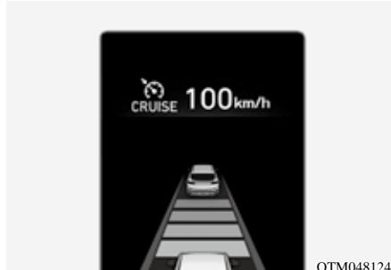
在智能巡航控制(SCC)功能控制期间，如果要加速，可以踩下加速踏板加速。车辆加速时，在仪表盘LCD显示屏上显示的巡航控制设定速度、设定车距等级和目标车距将会闪烁。
