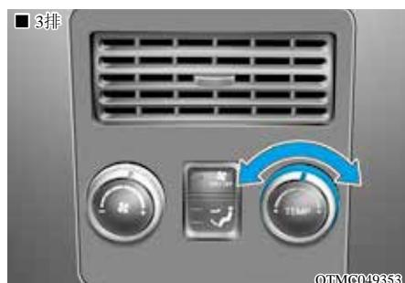
顺时针转动温度控制旋钮时，设置温度升高。
