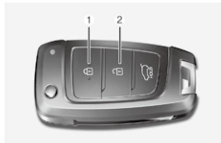
要闭锁车门，请按下遥控钥匙上的门锁闭锁按钮(1)。
