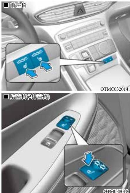
发动机运转期间，按下两个加热开关之一，加热驾驶位座椅或副驾驶座椅。
