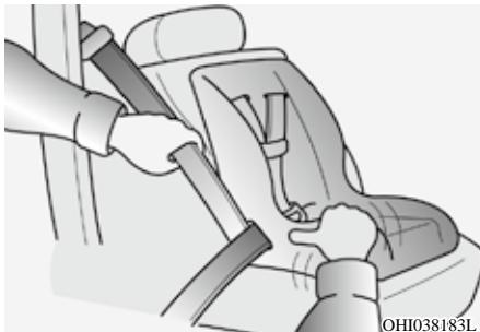
3. 向下按动儿童保护座椅，将肩部安全带束带的松弛部分收回至卷带器内，尽可能紧地收回安全带束带，以此完全消除松弛部分。
