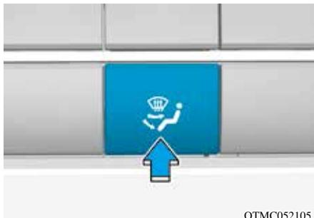
按动通风模式选择按钮，可以控制从通风系统流出的气流方向。
