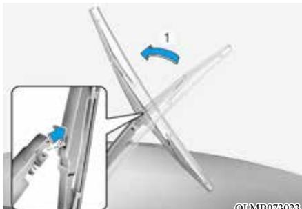
1. 向上提起雨刮器臂，并拔出雨刮器片总成。
