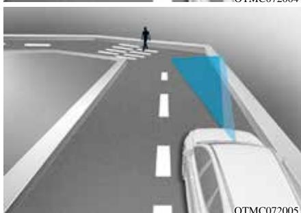
在弯道上行驶时，会严重影响正面防撞辅助传感器的检测性能，正面防撞辅助(FCA)功能可能检测不到弯道上前方的车辆或行人。这可能导致在必要时不发出碰撞危险预警、不采取紧急制动辅助控制措施。
