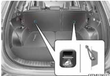
儿童保护座椅顶部拴带固定锚位于座椅靠背后部。
