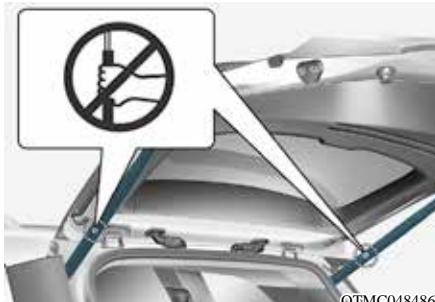
不要用力抓住后备箱门支撑杆(气体升降器)。否则, 可能导致支撑杆变形, 这潜在着人身伤害和车辆损坏的危险性。
