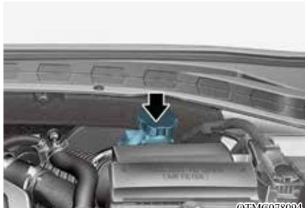
定期检查储油罐内的油量。油量应在储油罐侧面的“满(MAX)”与“低(MIN)”标记之间。
