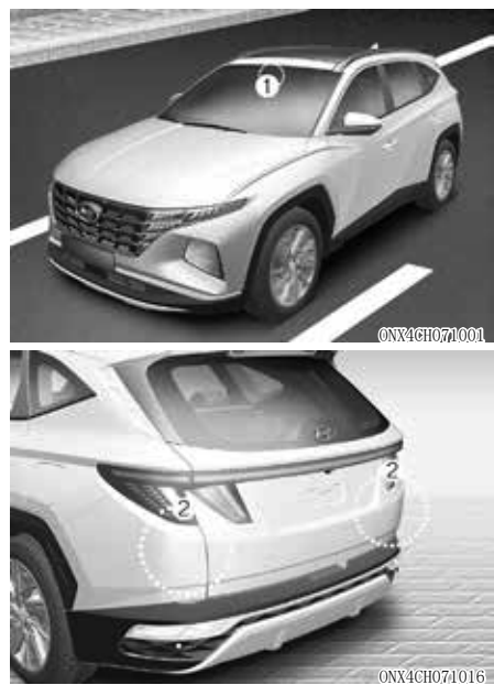
[1]：前视摄像头，[2]：后侧方盲区雷达传感器 参考上图，熟悉检测传感器的详细位置。
