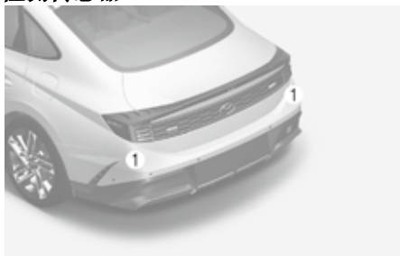
[1]: 后侧面雷达传感器 检测传感器的具体位置请见上图。
