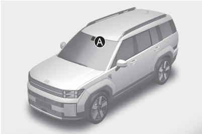
[A] 前视摄像头 使用前视摄像头检测车道线 (或道路边界)。
