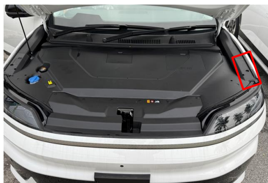
a) 分离机舱的维修用连锁连接器盖板
