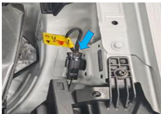
b) 分离维修用连锁连接器，如果无法分离请切断贴有黄色警告标签的电缆
