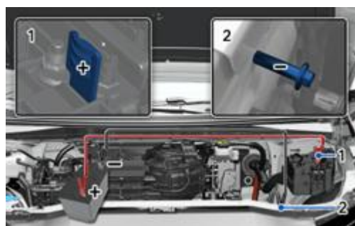
(1)正极+电池接线柱 (2)负极-电池接线柱
