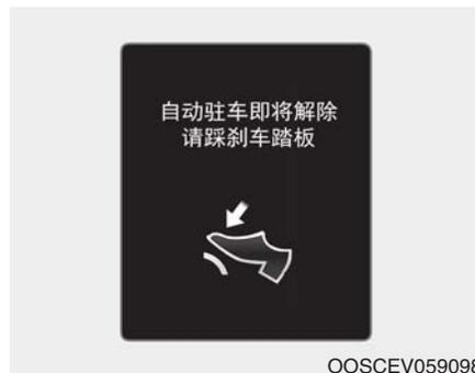
自动驻车即将解除 ... 请踩下制动踏板
