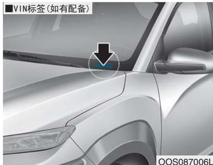
在仪表板顶部附着板件上也有 VIN, 从外部透过挡风玻璃可轻易看到这个板件上的号码。
