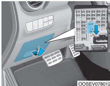
始终将保险丝开关置于 ON 位置。如果将开关移到 OFF 位置，必须复位某些项目如音响系统和数字时钟并且智能钥匙可能无法正常工作。
