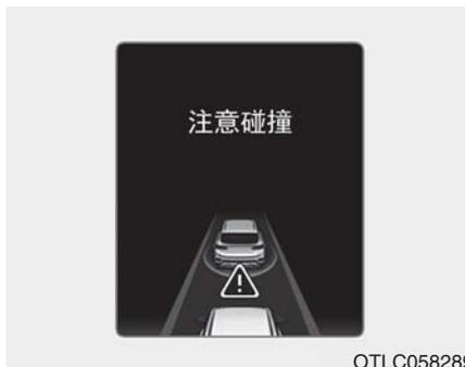
在 LCD 显示器上显示此警告信息，伴随着警报音。另外，一些车辆系统介入控制，会帮助减速车辆。
