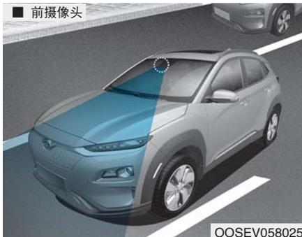
为使 FCA 系统能正常工作，总要确定传感器或传感器盖干净且没有灰尘、雪和碎片。
