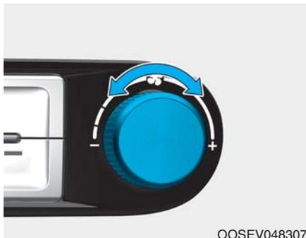
通过转动鼓风机速度控制旋钮，可把鼓风机速度设到理想速度。
