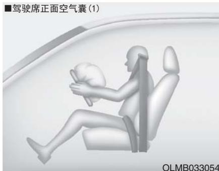
当 SRSCM 检测到车辆正面碰撞严重性达到一定程度时，自动展开正面安全气囊。
