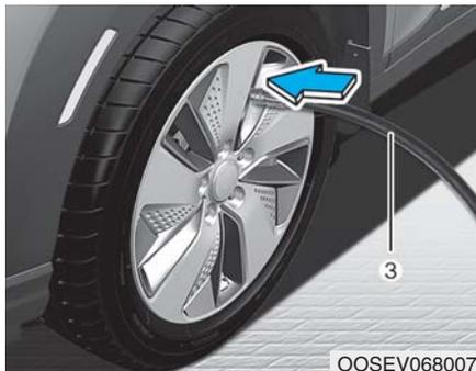
3. 将压缩机的填充软管 (3) 直接连接到轮胎充气阀上。
