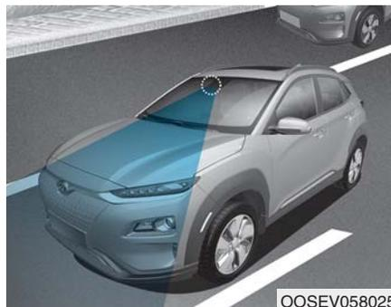
车道保持辅助 (LKA) 系统使用前挡风玻璃上的摄像头检测道路车道标志线，并辅助驾驶员进行转向控制，帮助将车辆保持在车道上。
