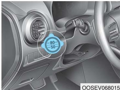
从密封胶瓶 (2) 上撕下限速标签 (1)，将其粘贴在车辆内显目的位置上，如方向盘上，以提醒驾驶员车速不要过快。
