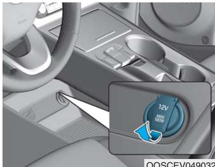
电源插座用于给手机或其它与车上的电气系统一起工作的设备提供电源。车辆处于就绪 (READY) 模式时, 此插座可获得 180W(瓦特) 以下的电流。
