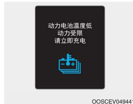
信息来保护电动汽车系统。如果高电压蓄电池电量较低，并且在低温下长期停放，车辆动力可能会受到限制。在驾驶前给蓄电池充电，这有助于增加动力。
