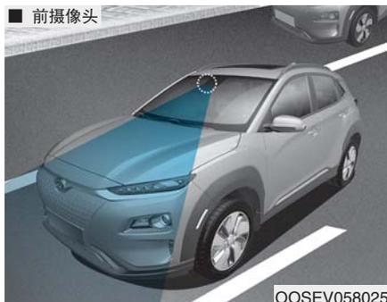
为使 FCA 系统能正常工作，总要确定摄像头干净且没有灰尘、雪和碎片。表面上的灰尘、雪或异物可能会对摄像头的传感性能产生不利影响。
