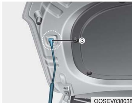
5. 用支撑杆(3)支撑打开的电机室罩。
