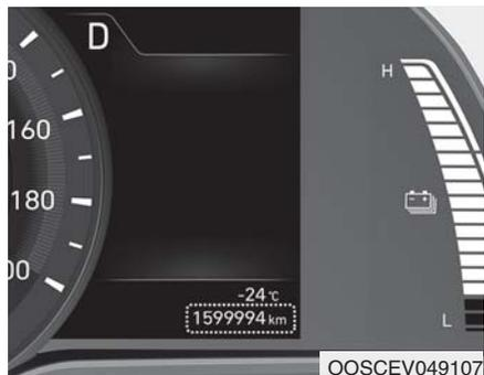
里程表显示车辆已行驶的总里程。使用里程表的显示值确定执行定期保养的时期。
