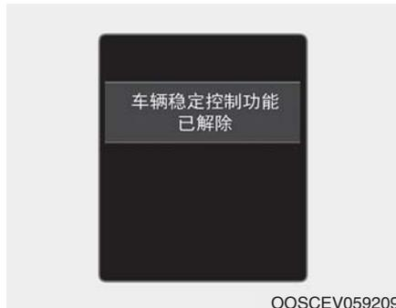
持续按住 ESC OFF 按钮超过 3 秒钟。ESC OFF 指示灯亮并显示“牵引力 & 稳定控制停用”信息，并且 ESC OFF 指示灯亮起。在此状态下，ESC 牵引力控制功能和 ESC 制动器控制功能均不工作。
