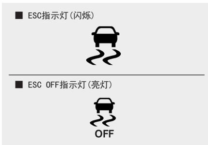
把电源按钮置于 ON 位置时，ESC 指示灯亮，然后在 ESC 系统正常工作时熄灭。
