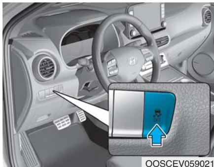
电子稳定控制 (ESC) 系统在车辆转弯过程中帮助稳定车辆。
