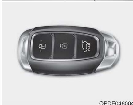
在随身携带智能钥匙的状态下，按下车门外侧手柄上的按钮或按下智能钥匙上的门锁闭锁按钮，可闭锁车门。
