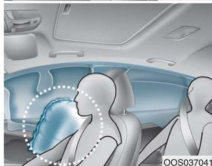
车辆的每个前座椅上都安装了侧面空气囊。
