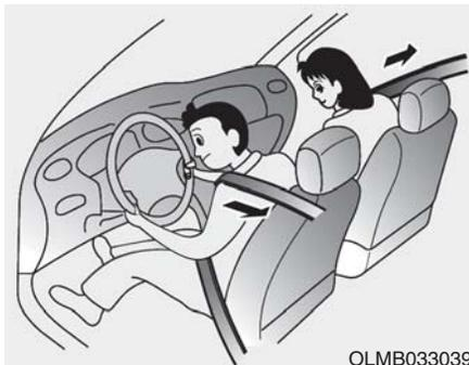
您车辆配备了安全带拉紧器（卷带器拉紧器）。配备此拉紧器的目的是为了在发生一定程度的正面碰撞事故时确保安全带紧固乘员的身体。当发生正面碰撞事故，其严重性达到一定程度时安全带拉紧器会与空气囊一起工作。
