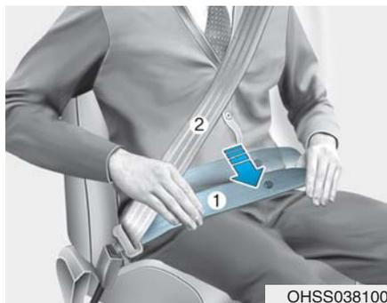
应将胯部安全带 (1) 部分绕过您的臀部，将肩部安全带 (2) 部分绕过您的胸部。
