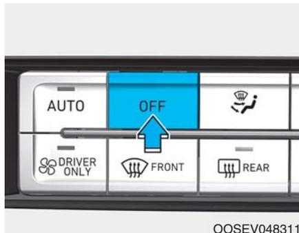
按下 OFF 按钮即可关闭空调控制系统。只要电源按钮置于“ON”位置，仍能操纵通风模式和内外气选择控制按钮。
