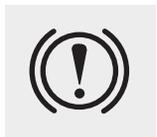
把电源按钮转至 ON 位置 (READY 指示灯 OFF)，检查驻车制动警告灯。
