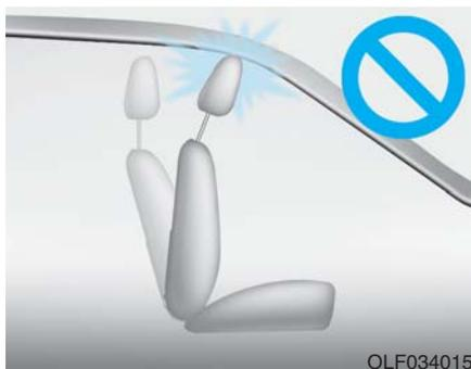
如果在头枕和座垫均升高的状态朝前倾斜座椅靠背，头枕可能接触遮阳板或车辆的其它部位。
