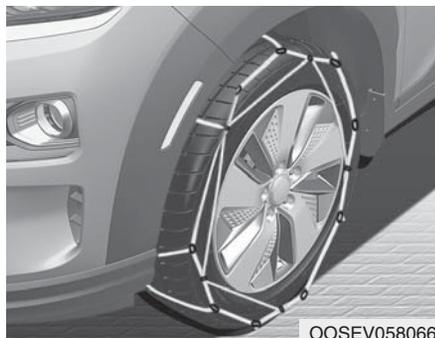
由于子午线轮胎侧围比其它类型的轮胎薄，如果在其上装配某些类型的防滑链，可能会损坏轮胎。因此使用推荐的防滑轮胎代替防滑链。不要在配备铝制车轮的车辆上安装轮胎防滑链；如果不可避免，使用导线防滑链。如果必须使用防滑链，使用北京现代正品配件并在审阅防滑链提供的说明书后，安装轮胎防滑链。由于防滑链使用不当而导致的车辆损坏，不属于车辆制造商的保修范围。
