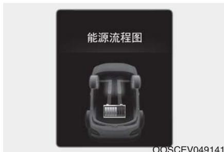
使用再生制动系统给高压蓄电池充电。
