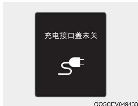
在充电口门未关的情况下驾驶车辆时，显示此信息。关闭充电口门后开始驾驶车辆。
