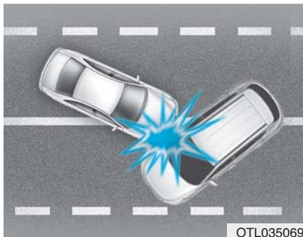
车辆发生角度的碰撞时，在撞击惯性力的作用下，乘员的身体会向安全气囊不能提供保护的方向移动，因此传感器可能不展开任何安全气囊。
