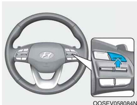
1. 按下方向盘上的巡航 (CRUISE) 按钮接通巡航控制系统。巡航控制指示灯亮。
