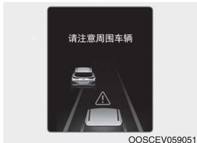
如果前车（车速：小于 30km/h）消失在下一车道，警报声响并且显示“观察周围车辆”信息。踩下制动踏板，调整车速以适应您车前突然出现的车辆或物体。
