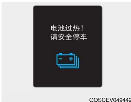
高电压蓄电池温度太高时，就会显示此警告信息，以保护蓄电池和电动汽车系统。
