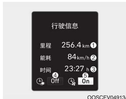
在每个行驶周期结束时, 显示行车信息。显示小计里程 (1)、平均油耗 (2) 和行驶时间 (3)、充电时间状态 (4) 和气候状态 (5)。
