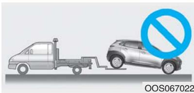
在不使用车轮台车的状态下紧急拖车时：
