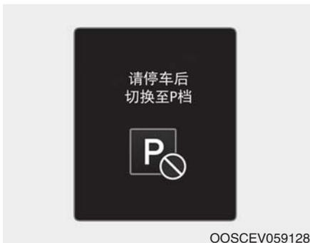
车辆移动时,如果尝试挂入“P(驻车)”档,就会在 LCD 显示器上显示此警告信息。
