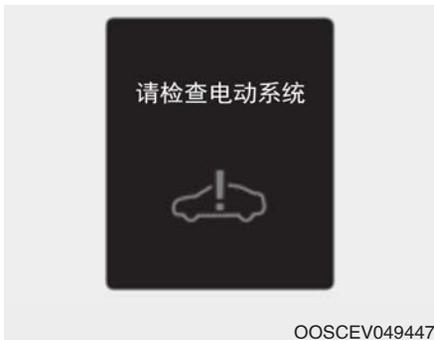
电动汽车控制系统有故障时，就会显示此警告信息。显示此警告信息时，停止驾驶操作。此时，请北京现代授权经销商检查车辆。
