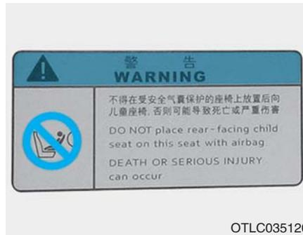
为了警告乘员空气囊系统的潜在危险性，附着了空气囊警告标签。
