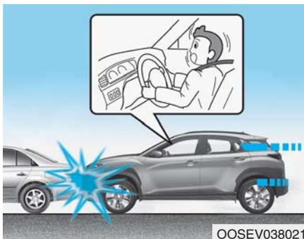
在某些低速碰撞中，安全气囊会不展开。安全气囊设计为在这些情况中不展开，因为在低速碰撞中，安全带能提供足够的保护，而安全气囊不能起到保护作用。
