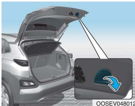
降低后备箱门然后向下按直到后备箱门闭锁。一定要试探性向上提起后备箱门进行检查，确定后备箱门牢固固定。
