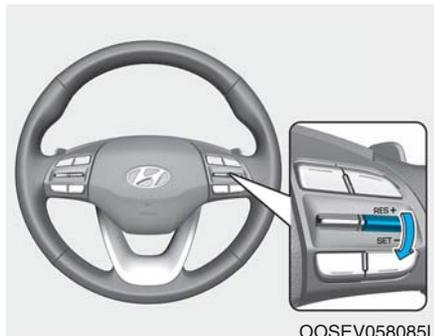
3. 向下推动拨动开关 (SET-)。LCD 显示器上的设定速度和与前车之间的车距标识亮。
