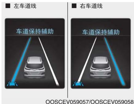
1. 仪表盘的 LCD 显示器上出现视觉警报。根据车辆的改变方向，仪表盘 LCD 显示器上的左车道标志线或右车道标志线闪烁。并且会发出警报声。
