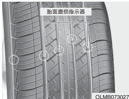
如果轮胎磨损均匀，胎面磨损指示器将作为横过胎面的硬带出现。这表示胎面剩余厚度不足 1.6mm(1/16in.)。此时应更换轮胎。
