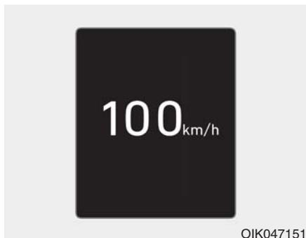
此数字式车速表显示当前车速(km/h、MPH)。
