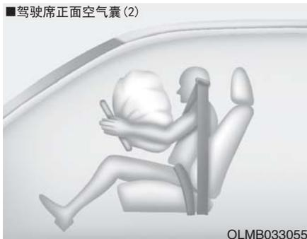
安全气囊展开时，直接模压在装饰盖内的撕裂接缝会在安全气囊的膨胀压力作用下被分离。装饰盖进一步打开，安全气囊膨出完全展开。
