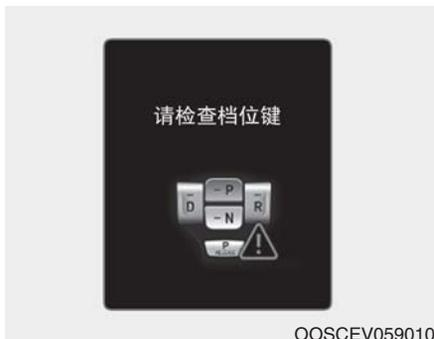
如果换挡按钮故障，就会在 LCD 显示器上显示此警告信息。
