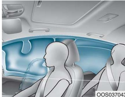
窗帘式空气囊位于前后车门上方车顶纵梁的两侧。
