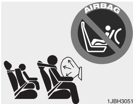
禁止在助手席座椅上安装儿童保护座椅，除非停用安全气囊。
