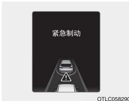
在 LCD 显示器上显示此警告信息，伴随着警报声。另外，一些车辆系统介入控制，会帮助减速车辆。
