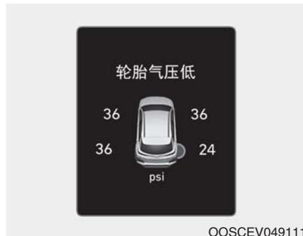
轮胎压力监测系统警告灯亮时，仪表盘 LCD 显示器上显示一条警告信息，说明您车辆的一个或多个轮胎充气压力明显不足。此低压轮胎位置指示灯通过点亮对应位置指示灯指示充气压力明显过低的轮胎位置。
