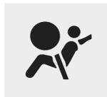
仪表盘上的 SRS(辅助保护系统)空气囊警告灯显示如图所示空气囊符号。系统检查空气囊电气系统是否有故障。此灯指示有空气囊系统潜在故障。
