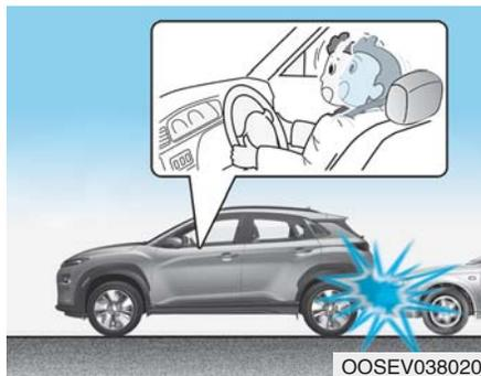
正面安全气囊设计为在车辆后部发生碰撞时不展开。因为在车辆后部发生碰撞时，在撞击惯性力的作用下，乘员的身体会向后移动，因此即使正面安全气囊展开也不能提供任何保护。
