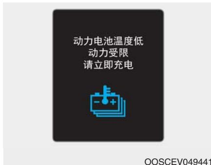
当室外温度较低时，会显示两个警告信息来保护电动汽车系统。如果高电压蓄电池电量较低，并且在低温下长期停放，车辆动力可能会受到限制。
