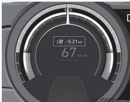
如果按下驱动模式按钮选择 ECO/ECO+ 模式，则显示从再生制动系统再生的能量转换的额外续航里程。如果再生制动因加速等原因停止，则将显示初始化为 0。
