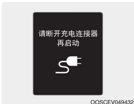
在没有断开充电连接器的情况下启动车辆时，就会显示此警告信息。断开充电连接器，启动车辆。
