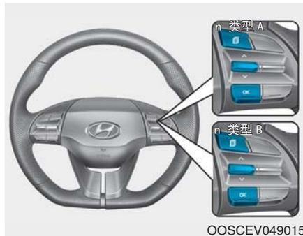
要变换行车电脑模式，拨动方向盘上的“∧，∨”开关。
