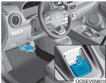
要释放电动驻车制动 (EPB)，在下列情况中按下 EPB 开关：
