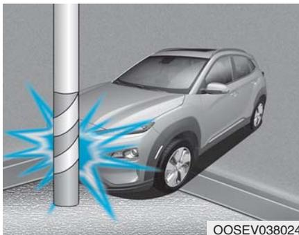
如果车辆与某些物体，如电线杆或树木等发生碰撞，在这种碰撞中，碰撞点集中在某个位置，并且碰撞能量被车辆结构吸收，所以安全气囊可能不展开。
