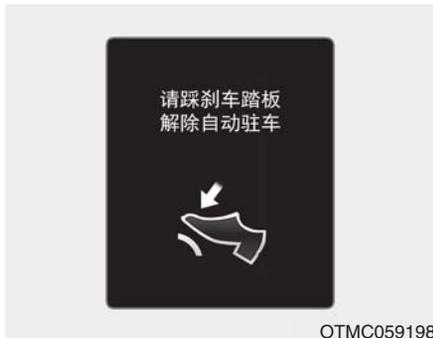
请踩下制动踏板，解除自动驻车。在您按下自动驻车 [AUTO HOLD] 开关释放自动驻车功能时，如果您没有踩下制动踏板，警报声响，并显示此警告信息。
