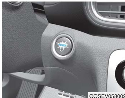
无论何时打开前车门，电源按钮照明灯亮，车门关闭 30 秒之后照明灯熄灭（如有配备）。
