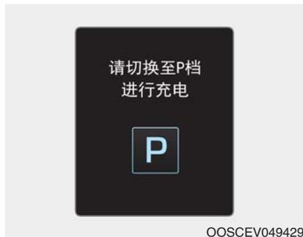
如果您在没有将变速杆置于“P(驻车)”档的情况下连接充电线，就会显示此警告信息。
