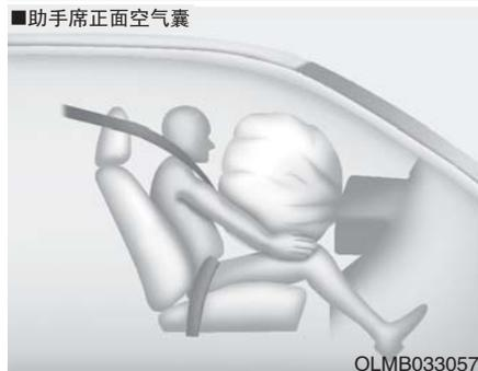
安全气囊完全展开后立即开始放气，使驾驶员能够维持前方视野并能执行转向或操作其它控制。
