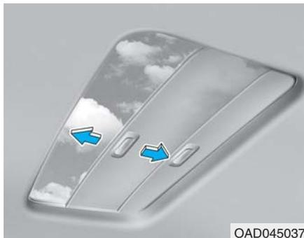
当天窗玻璃板滑动打开时，遮光板会自动随天窗玻璃板打开。如果要关闭遮光板，手动操作关闭遮光板。
