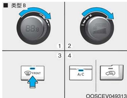
1. 将鼓风机速度设到最大速度 (极右) 位置。
