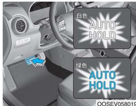
2. 踩下制动踏板完全停车时，自动驻车 (AUTO HOLD) 维持制动压力，保持车辆静止状态。指示灯颜色由白色变为绿色。
