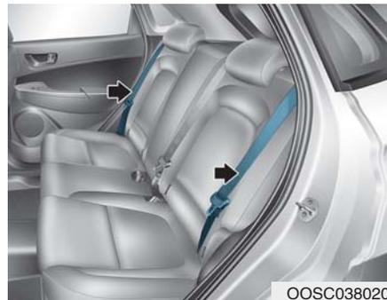
3. 向下折叠座椅靠背时，将座椅安全带置于靠背外侧位置，以防止座椅安全带系统干扰座椅靠背。
