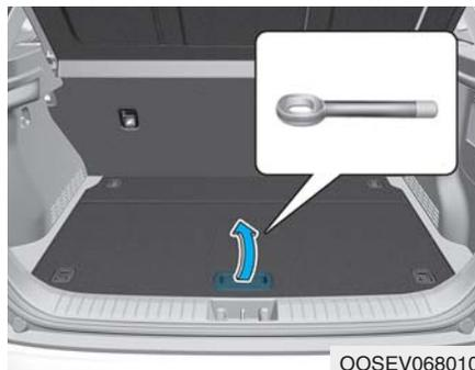
1. 打开后备箱门，从工具箱中拿出牵引挂钩。工具箱放置在行李箱托盘的下方。
