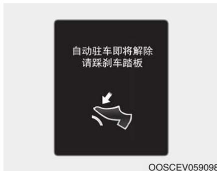
自动驻车即将解除 ... 请踩刹车踏板
