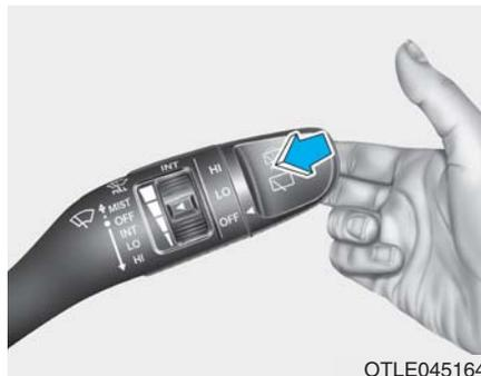
在 OFF(O) 位置, 朝您所在方向轻拉开关杆, 向挡风玻璃喷射清洗液并并运转雨刮器 1-3 周期。喷水器及雨刮器持续工作, 直到您释放开关杆为止。如果喷水器不工作, 可能需要在喷水器液储液箱内添加喷水器液。
