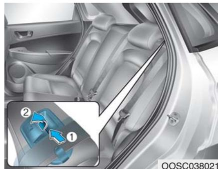
4. 在导轨 (1) 放置好安全带并提起座椅靠背折叠杆 (2)，然后向车辆前方折叠座椅靠背。
