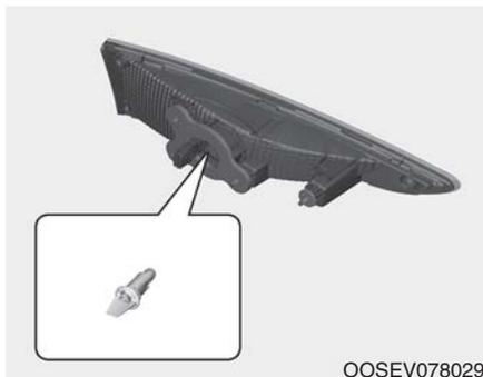
4. 逆时针转动灯泡插座直到灯泡插座上的舌片对正总成上的导槽，即可从总成上拆下灯泡插座。
