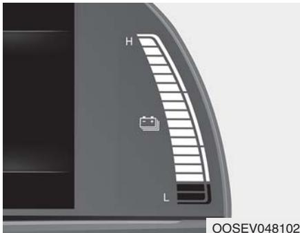
SOC 仪表显示高电压蓄电池的充电状态。
