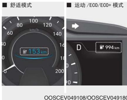
在驾驶模式集成控制系统中，根据所选的驾驶模式，显示不同的续航里程。有关更详细信息请参考第 5 章的“驱动模式集成控制系统”部分。
