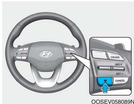
智能巡航控制系统 ON 时，设置与前车之间的车距，并可以在不操作加速踏板或制动踏板状态保持与前车之间的车距。
