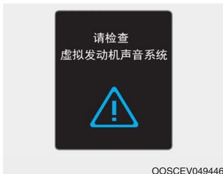
虚拟发动机声音系统 (VESS) 有故障时，就会显示此警告信息。此时，请北京现代授权经销商检查车辆。
