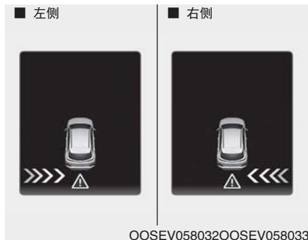
如果传感器检测到的车辆正接近您车辆时, 发出警报, 室外后视镜上的警告灯闪烁, 并且在 LCD 显示器上显示此警告信息。
