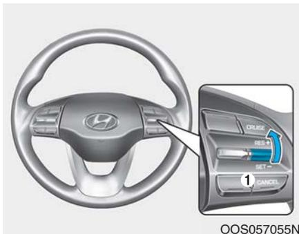
向上推动拨动开关 (1)(RES+)。如果车速超过 30km/h(20mph), 车辆恢复到预设速度。
