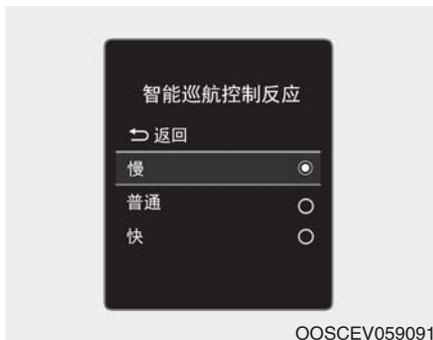
可调整跟随前车行驶时维持设定车距的车速灵敏度。转至 LCD 显示器上的“用户设置→驾驶席辅助→SCC 响应性→慢/普通/快”。您可根据喜好选择三种模式之一。
